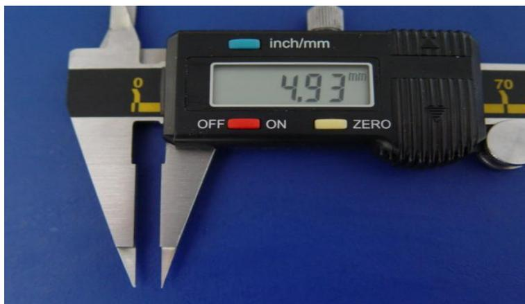
Figura 9 - Pontas do paquímetro.
