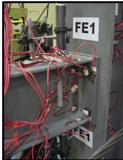
Figura 3.3 – Ligações com placa de extremidade ajustada (Lima, 2003)
