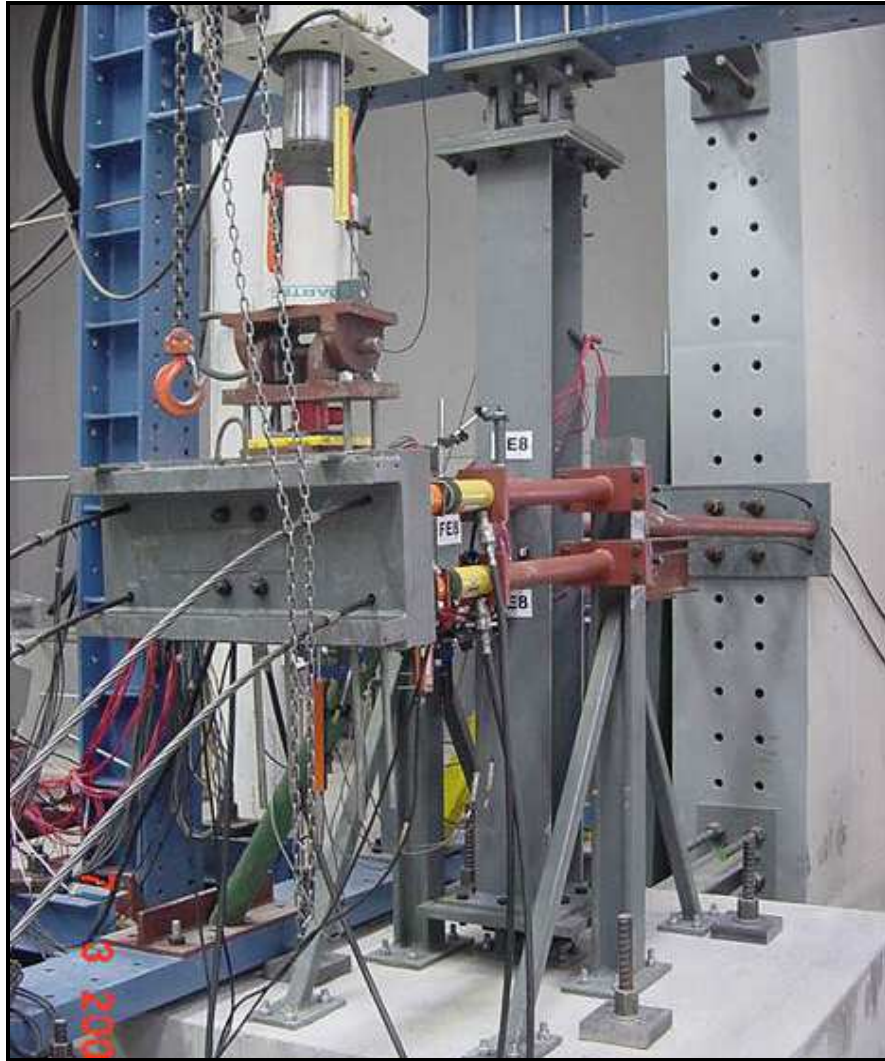
Figura 3.6 – Pórtico de aplicação da carga
