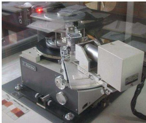
**Figura 3.3.** Difratômetro de raios-X do Laboratório de Microscopia Óptica (DEGEO) da Universidade Federal de Ouro Preto.
