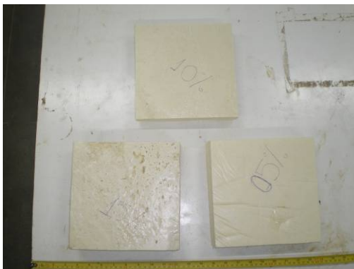
Figura 4.16 – Corpos de prova para ensaio de desempenho térmico
