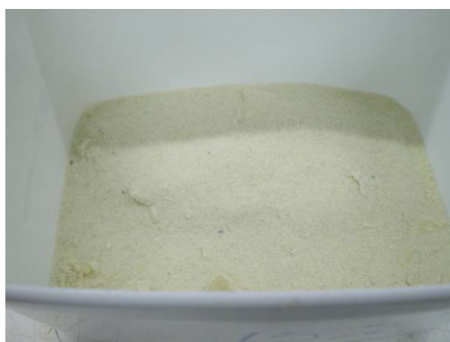
Figura 4.9 – Compósito com 15% de resíduo moído
