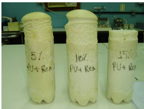
Figura 4.11 – Corpos de prova PU mamona com compósitos moídos
