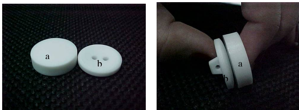
Figura 3.1 – (a) botão antes da usinagem e do acabamento; (b) botão após usinagem e acabamento.
