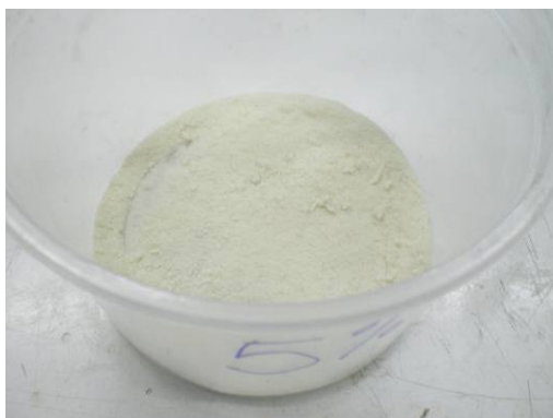
Figura 4.7 – Compósito com 5% de resíduo moído
