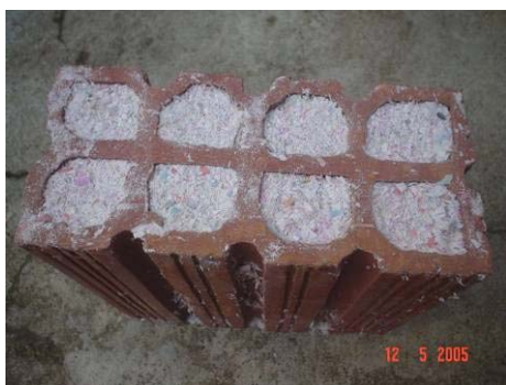
Figura 3.4 - Blocos cerâmicos 8 furos com e sem resíduo
