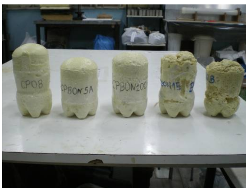
Figura 4.5 – Corpos de prova PU mamona com resíduo plástico
