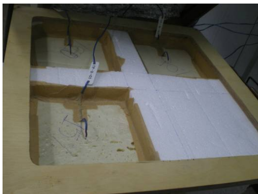
Figura 4.27 – Termopares na face voltada para a câmara de baixa temperatura
