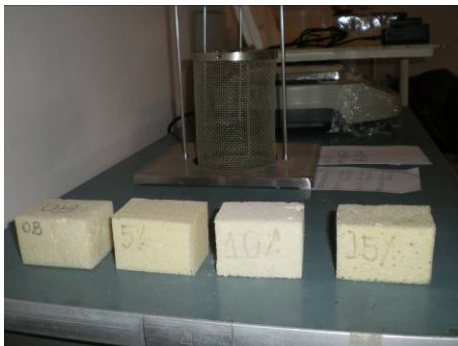
Figura 4.19 – Corpos de prova para determinação da massa específica
