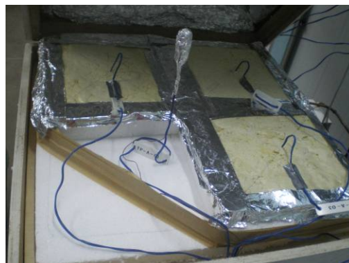
Figura 4.28 – Termopares na face voltada para a câmara de alta temperatura
