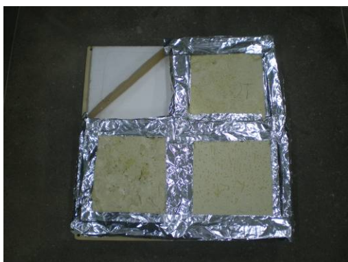
Figura 4.25 – Placas isoladas com EPS, filme aluminizado e fita adesiva
