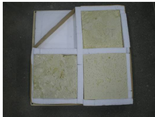
Figura 4.24 – Placas isoladas com EPS e fita adesiva
