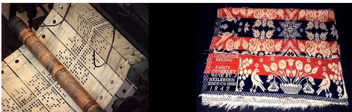
Figura 7. À esquerda, tiras de papel perfuradas utilizadas nos teares de Jacquard. À direita, peça de tecido produzida nos mesmos teares e datada de 1842.
