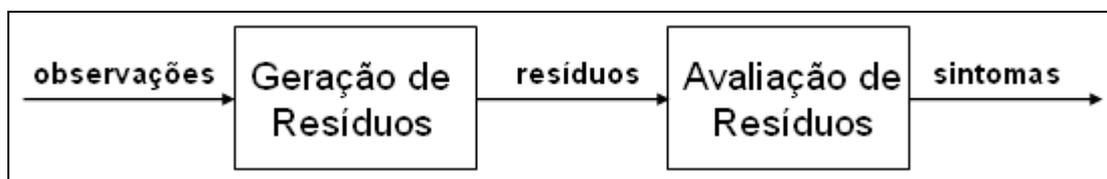
Figura 5: Etapas da Detecção de Falha
