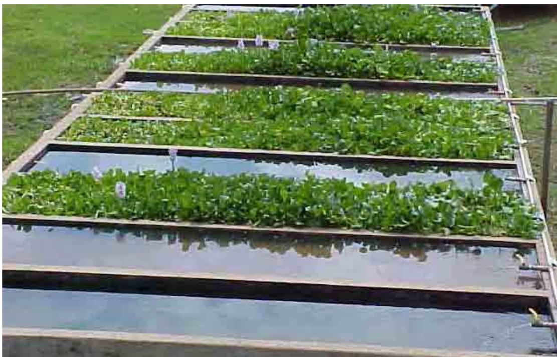
Figura 5. “CWS” utilizados durante o experimento, vegetado com *Eichhornia crassipes*.
