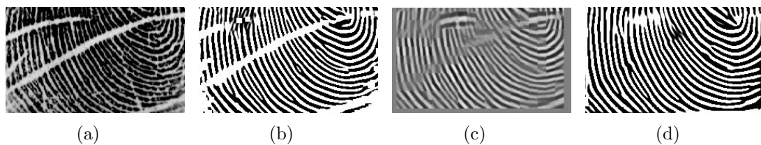
Figura 4.4: Processo de reconstrução das cristas: (a) região da imagem original; (b) Filtro de Gabor; (c) STFT; (d) Gabor + STFT.
