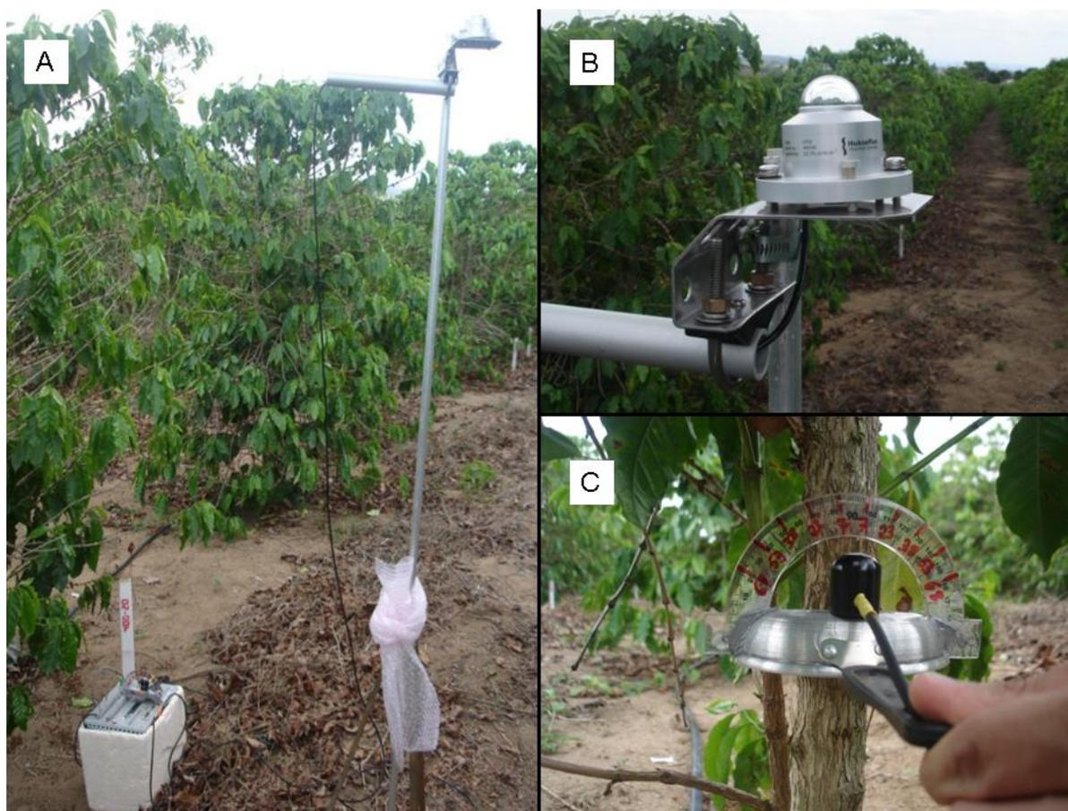
Figura 7. Equipamento baseado no LAI 2000 (A), detalhes do sensor piranômetro termopar modelo LP02 (B) e do sensor fotodiodo de silício modelo CS300 (C)
