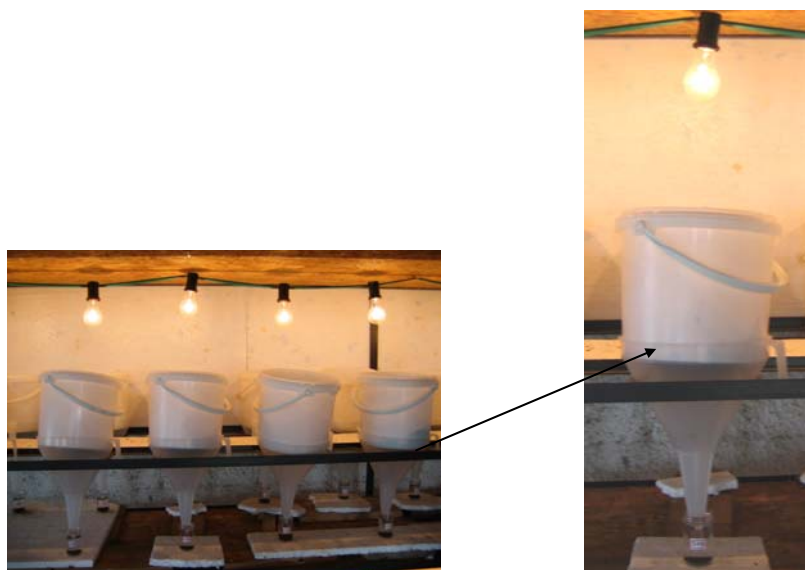
FIGURA 9 - IMAGENS DO EQUIPAMENTO EXTRATOR, COM DETALHE PARA UM DOS FUNIS DE BERLESE, UTILIZADOS PARA EXTRAÇÃO DA MESOFAUNA DAS AMOSTRAS DE SOLOS COLETADAS. ANTONINA, PR - 2004
