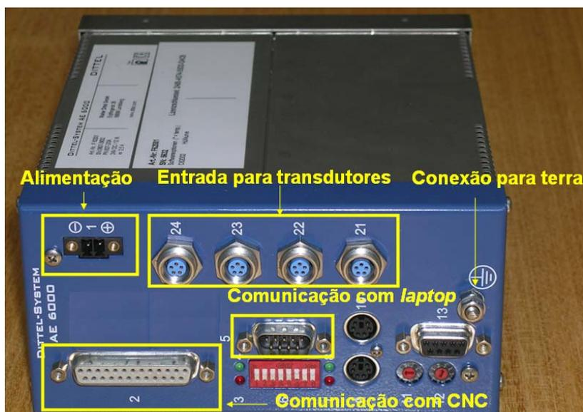
**Figura 3.6** – SM-D e principais conexões utilizadas durante ensaios.
