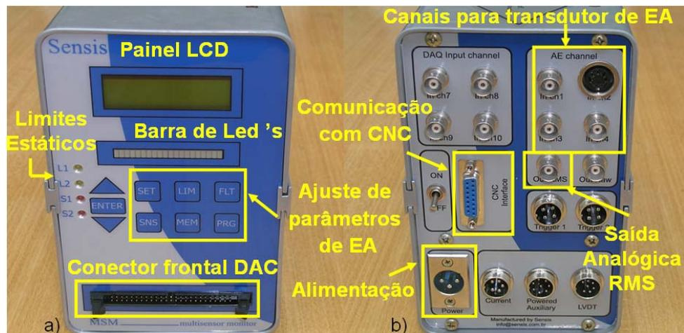
**Figura 3.8** – Principais componentes utilizados no SM-S. a) Painel frontal. b) Painel traseiro.
