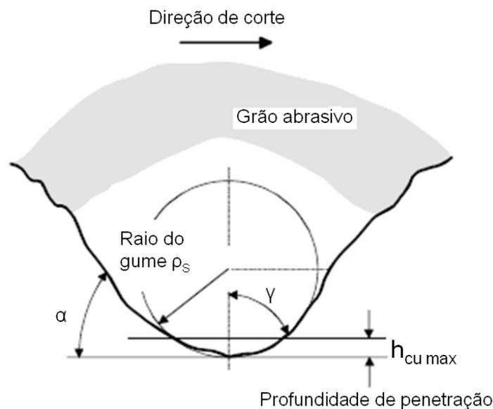
**Figura 2.2** – Representação esquemática do perfil médio de um gume na retificação [2].
