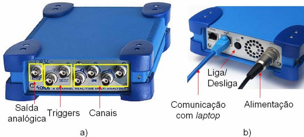
**Figura 3.9** – Sistema multianalisador Oros OR-34.
