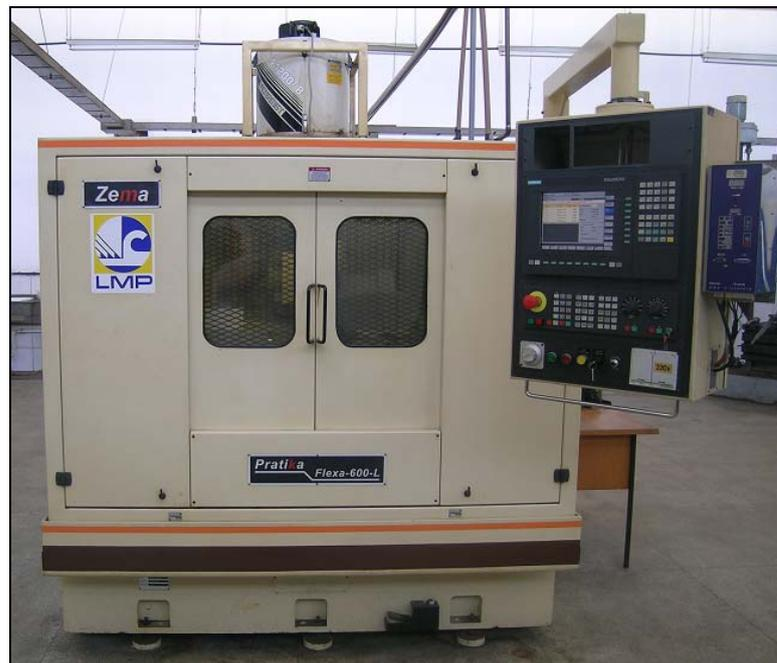
**Figura 3.1** – Retificadora cilíndrica universal Pratika Flexa-600L.
