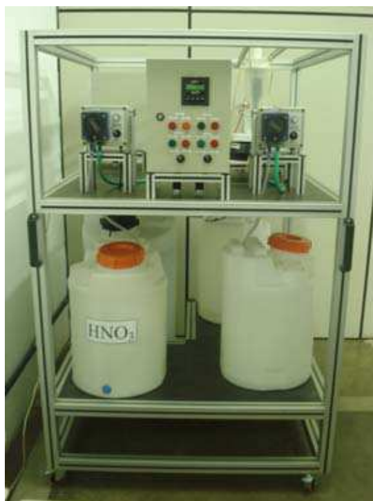
Figura 5.1: Foto frontal da planta piloto de neutralização de pH
