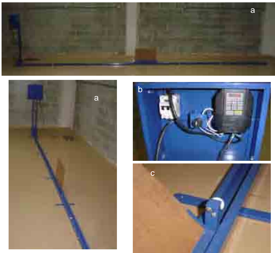
Figura 2. Sistema de tração do obstáculo: a) estrutura mecânica do sistema; b) caixa de controle eletrônico; c) carrinho, obstáculo e mecanismo de destravamento.
