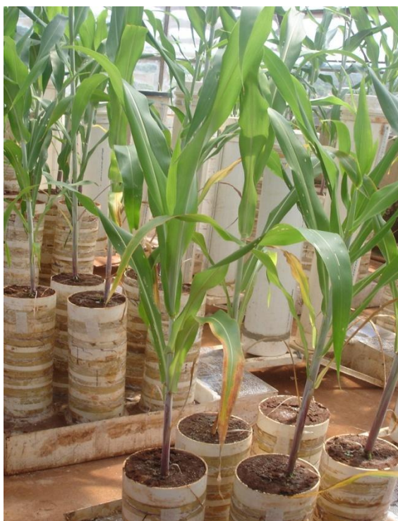
Figura 2. Conjunto de vasos e bandejas para a mensuração da evapotranspiração da cultura.
