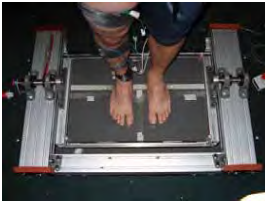
Figura 17. Foto da situação experimental, vista de cima e anteriormente (a) e posteriormente (b), com um participante posicionado na plataforma, com pés distantes 6,5 cm e maléolos mediais coincidindo com o eixo de rotação da plataforma.
