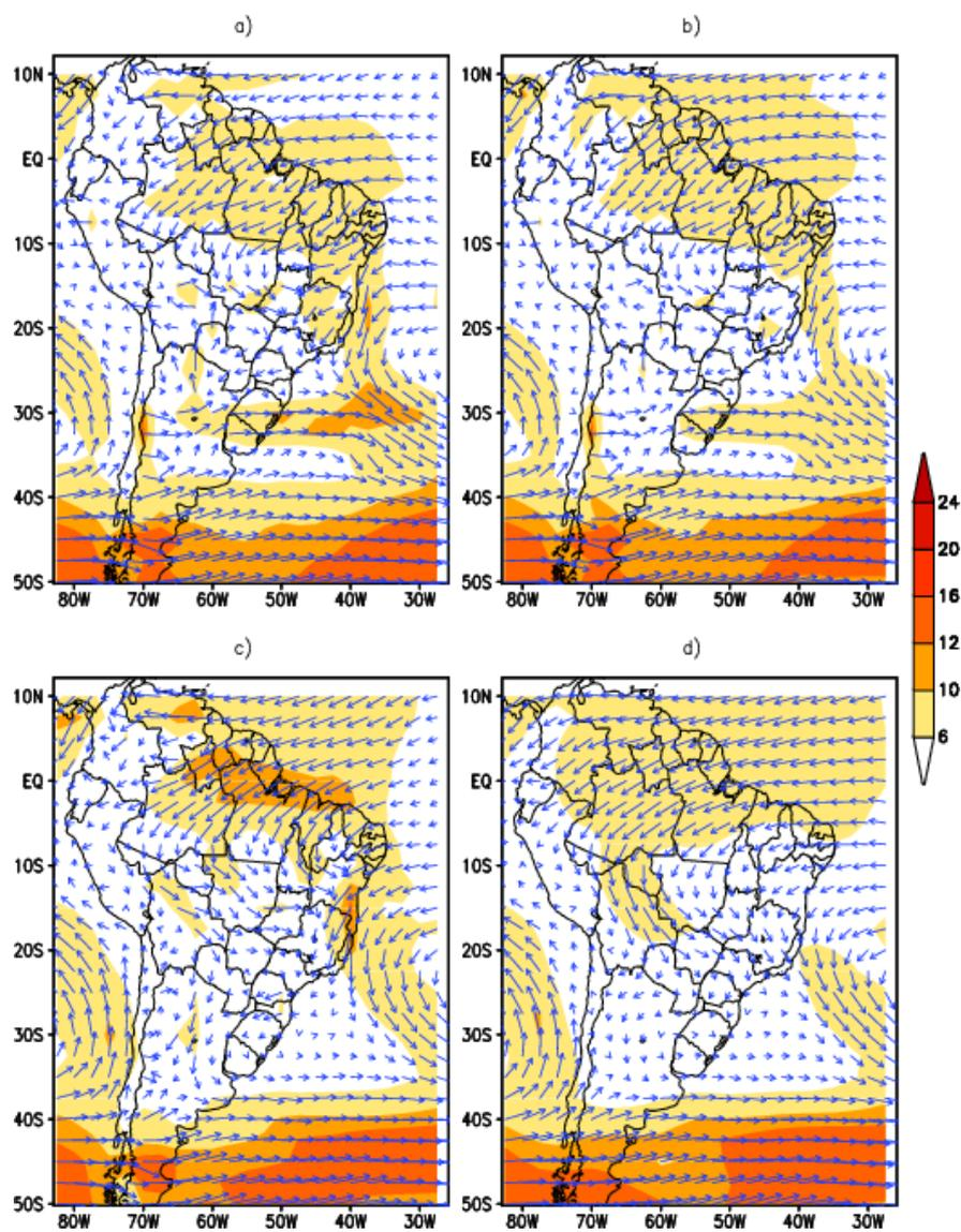
Figura 3.8 - Magnitude e direção do vento ( $u+v$ ) para o nível de 850 hPa. a) experimento SAP, b) experimento CAP, c) Reanálise CPTEC, d) Reanálise 2 NCEP/DOE. As unidades estão em ms-1.
