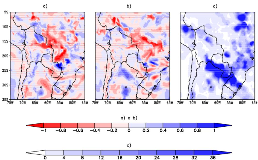
Figura 4.8 - Velocidade vertical em 700 hPa para os experimentos a) SAP e b) CAP. Em ambos os casos são mostradas as previsões de 6 horas. Em c) precipitação observada do SALLJEX. Os contornos em azul-claro apresentam valores iguais a  $-0.2$  Pa/s.
