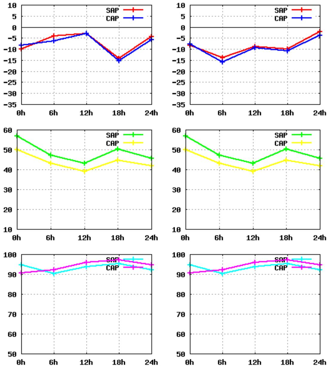
Figura 3.27 - Viés, EQM e CA para a variável altura geopotencial em 500 hPa. A coluna da esquerda mostra os valores das medidas para o horário das 00Z. A coluna da esquerda mostra os valores das medidas para o horário das 12Z.
