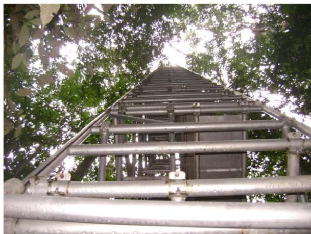
Figura 4. Torre micrometeorológica (parcela A)
