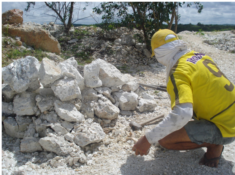
Figura 7: Ausência de equipamentos de proteção.
