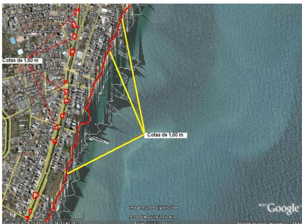
Figura 17- Curvas de Nível com cota de 1,60 metros (em vermelho), para o bairro de Boa Viagem, da cidade do Recife.
