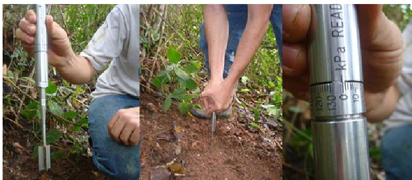
FIGURA 12 Resistência ao cisalhamento do solo pelo ensaio de palheta.
