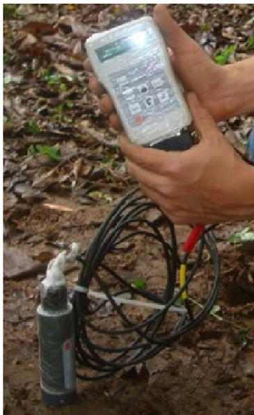
FIGURA 7 Sensor o umidade ML2X da Delta-T Devices Ltda.
