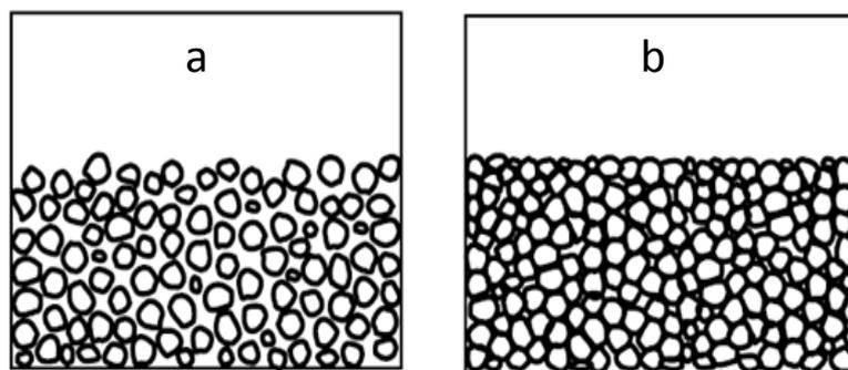
FIGURA 1 Representação esquemática de um solo descompactado (a) e um solo compactado (b).
