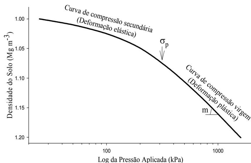
FIGURA 2 Curva de compressão do solo mostrando a curva de compressão secundária, a curva de compressão virgem, a pressão de preconsolidação ( $\sigma_p$ ) e o índice de compressão ( $m$ ).
