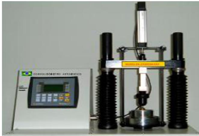
FIGURA 8 Consolidômetro automático com IHM Modelo CNTA-IHM/BR-001/07.
