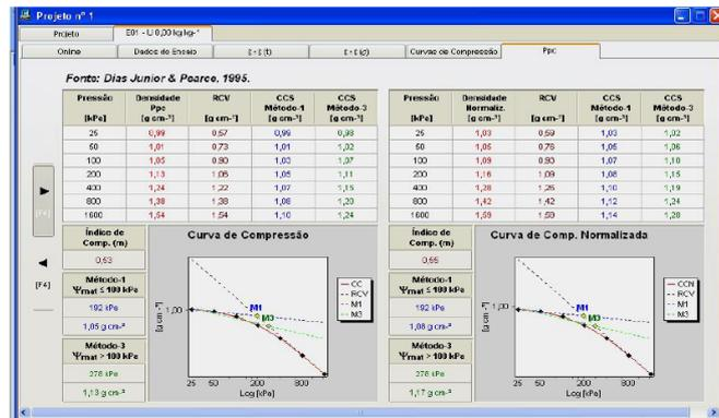
FIGURA 10 Informações de um ensaio, exibindo a curva de compressão do solo e estimativas da  $\sigma_p$ , densidade do solo ( $D_s$ ) referente a  $\sigma_p$  e o índice de compressão ( $m$ ), conforme sugestão de Dias Júnior & Pierce (1995).
