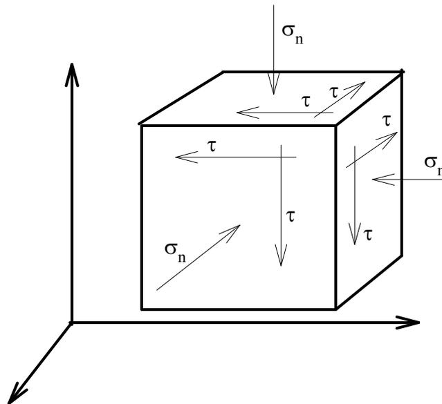
FIGURA 3 Componentes das tensões atuantes no solo, tensão normal ( $\sigma_n$ ) e tensão cisalhante ( $\tau$ ).
