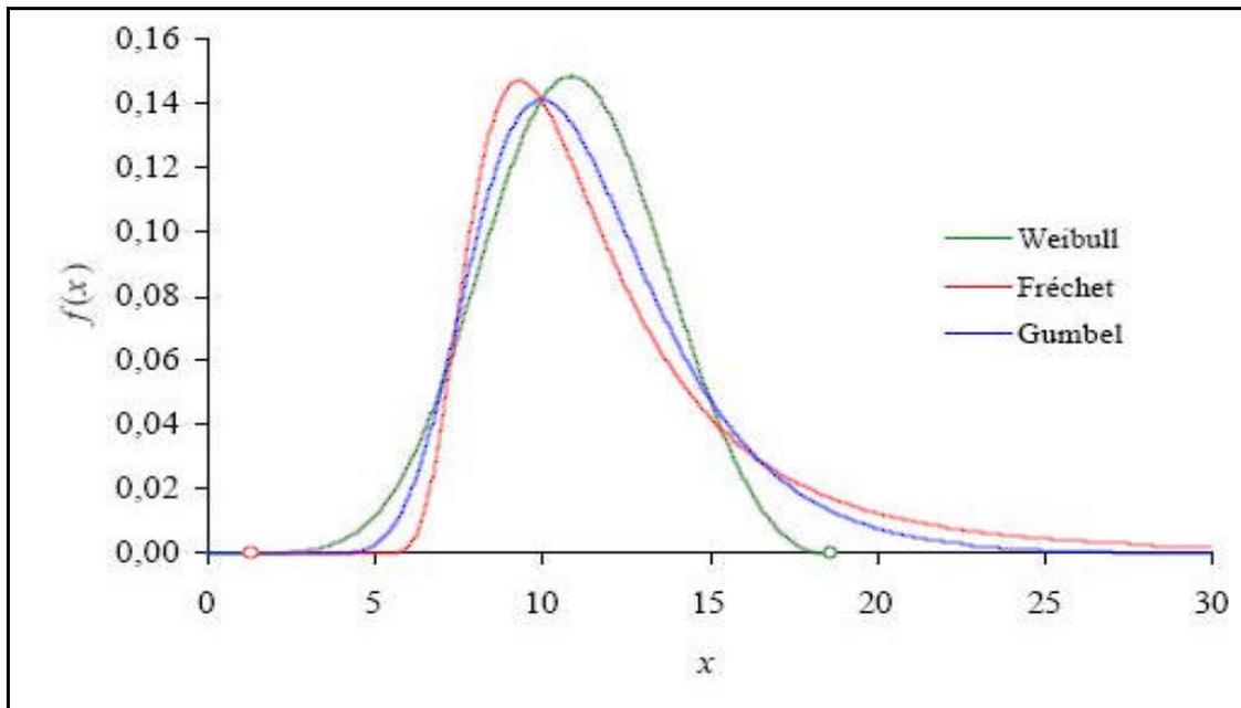
Figura 3.1 – Função densidade de probabilidade da distribuição generalizada de valores extremos (GVE) para  $\eta = -0,3$  (Weibull),  $\eta = 0$  (Gumbel) e  $\eta = 0,3$  (Fréchet), com  $a = 10$  e  $\beta = 2,6$ .
