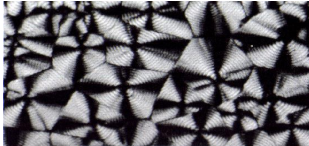
Figura 3.5: Micrografia ótica com luz polarizada dos esferulitos do polietileno 3 .
