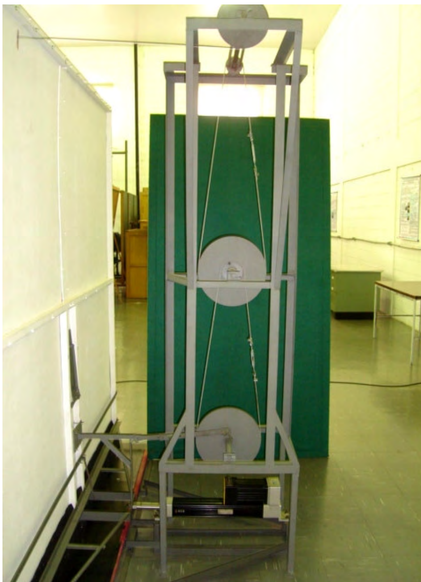
Figura 1A. Foto do sistema de roldanas acoplado ao servo-mecanismo.
