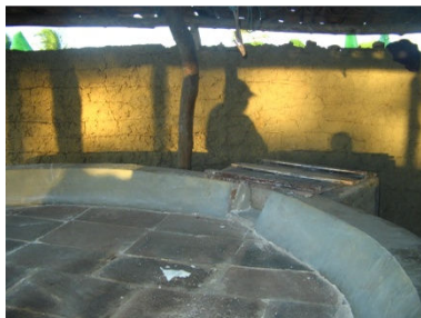
No centro da casa de farinha, o forno onde é feito o cozimento da goma da macaxeira. No teto, as pás utilizadas no momento do cozimento.
