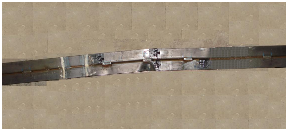
Figura 4.7 – Ruptura por Plastificação da Mesa Comprimida com FLT – Vigas da série A
