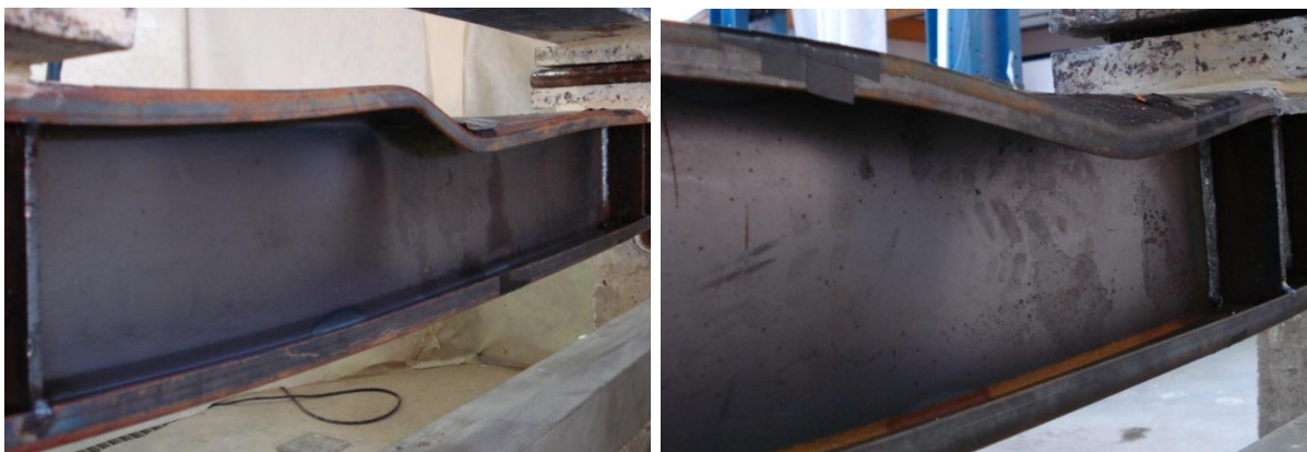
Figura 4.8 – Ruptura por Distorção da Seção Transversal – Vigas da série B
