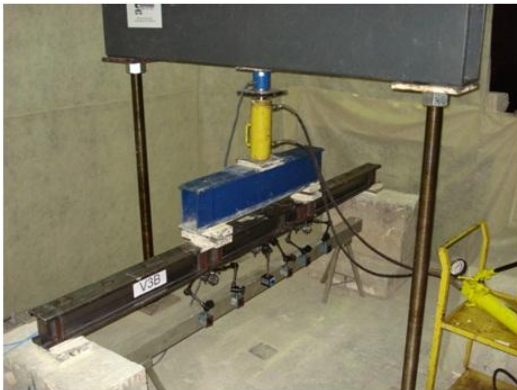
Figura 3.18 – Esquema montado para ensaio de viga
