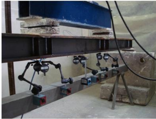
Figura 3.27 – Defletores posicionados na viga
