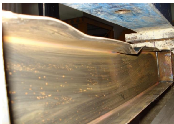
Figura 4.5 –Plastificação da Mesa Comprimida – Vigas da série A
