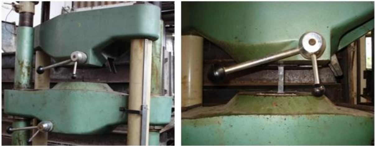
Figura 4.3 – Corpo de prova com emenda soldada no momento do ensaio
