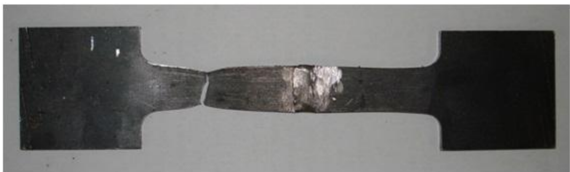
Figura 4.4 – Corpo de prova com emenda soldada rompido
