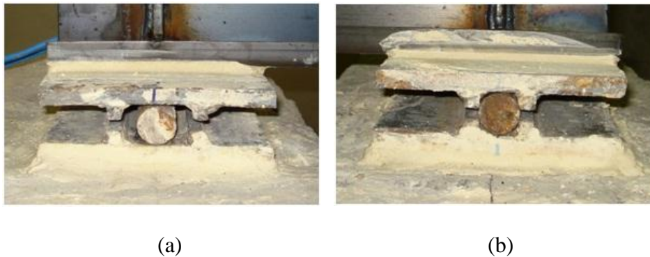
Figura 3.16 – Apoios das vigas de ensaio (a) Apoio de primeiro gênero; (b) Apoio de segundo gênero.
