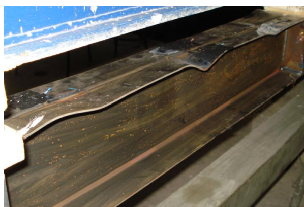
Figura 4.6 – Formação de meia ondas senoidais – Vigas da série A
