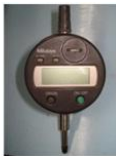
Figura 3.28 – Defletor utilizado nas leituras dos deslocamentos verticais
