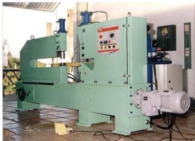
Figura 2.4 – Tesoura rotativa (Arquivo pessoal)
