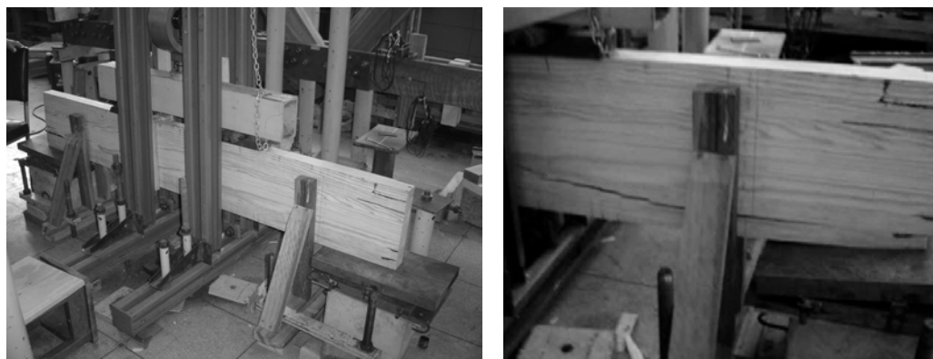
Figura 5.8 – Forma A: Ruptura predominante por cisalhamento na madeira, e em alguns trechos pequenos de linhas de cola alternadas.
