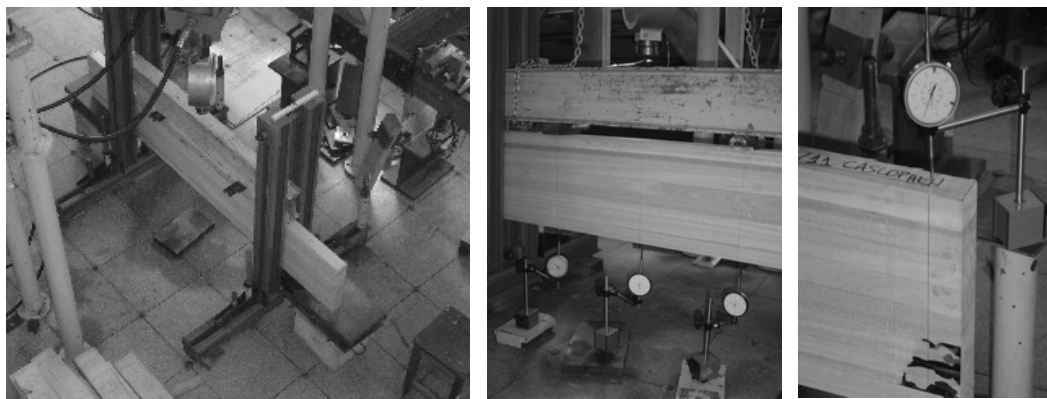
Figura 5.6 - Esquema estático das vigas de MLC ensaiadas.
