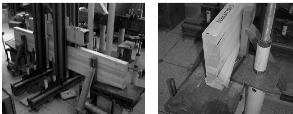
Figura 5.11 – Forma E: Esmagamento na região do apoio.
