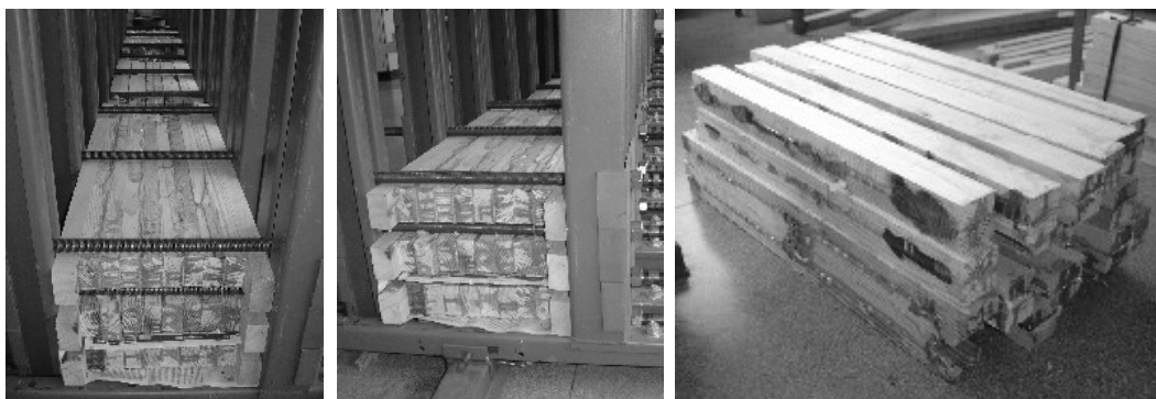
Figura 4.1 – Esquema de prensagem das lâminas de cisalhamento.
