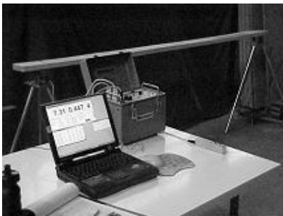
Figura 2.9 - Equipamento para a determinação do MOE por vibração transversal.
