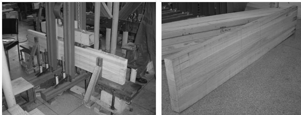
Figura 5.9 – Forma B: Ruptura por cisalhamento na madeira e na linha de cola, alternadamente, e em proporções semelhantes.
