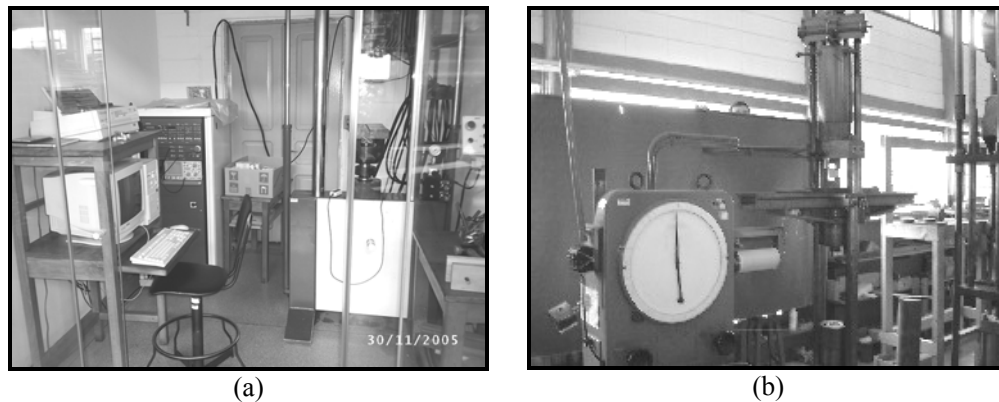
Figura 3.16 – (a) Máquina de ensaio DARTEC M1000/RC e (b) máquina universal de ensaio AMSLER.
