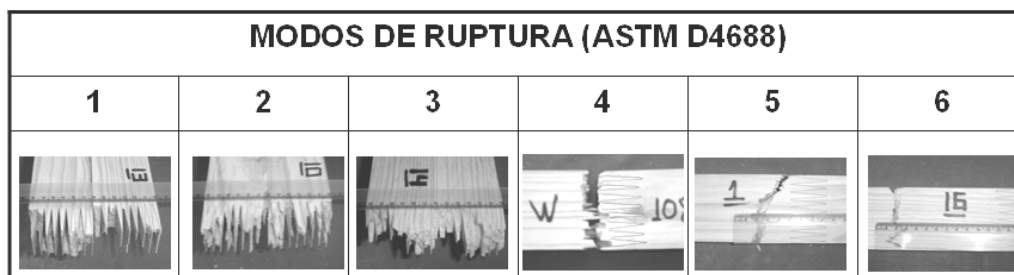
Figura 3.17 - Exemplos de rupturas ocorridas em cada modo.
