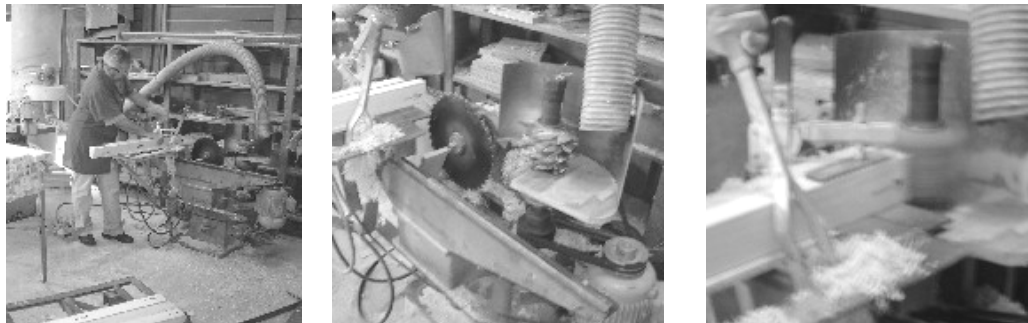
Figura 3.9 - processo de fabricação das emendas.
