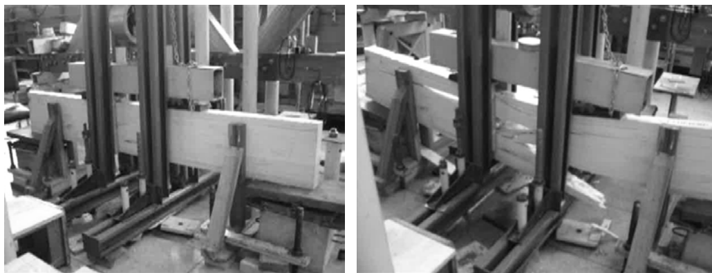
Figura 5.10 – Forma D: Ruptura por tração na borda inferior, propagando por cisalhamento.
