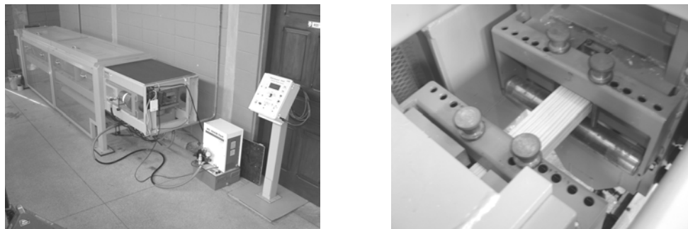
Figura 3.15 - Ensaio de tração em peças com dimensões estruturais.
