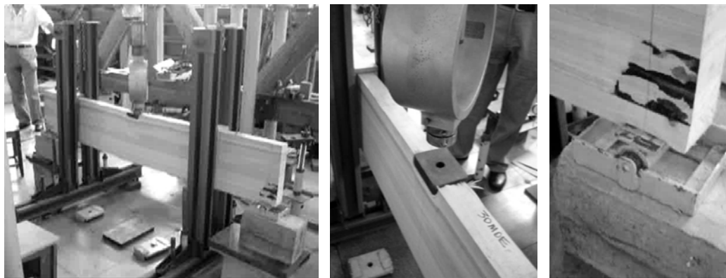
Figura 5.3 - Esquema estático do ensaio das vigas de MLC.
