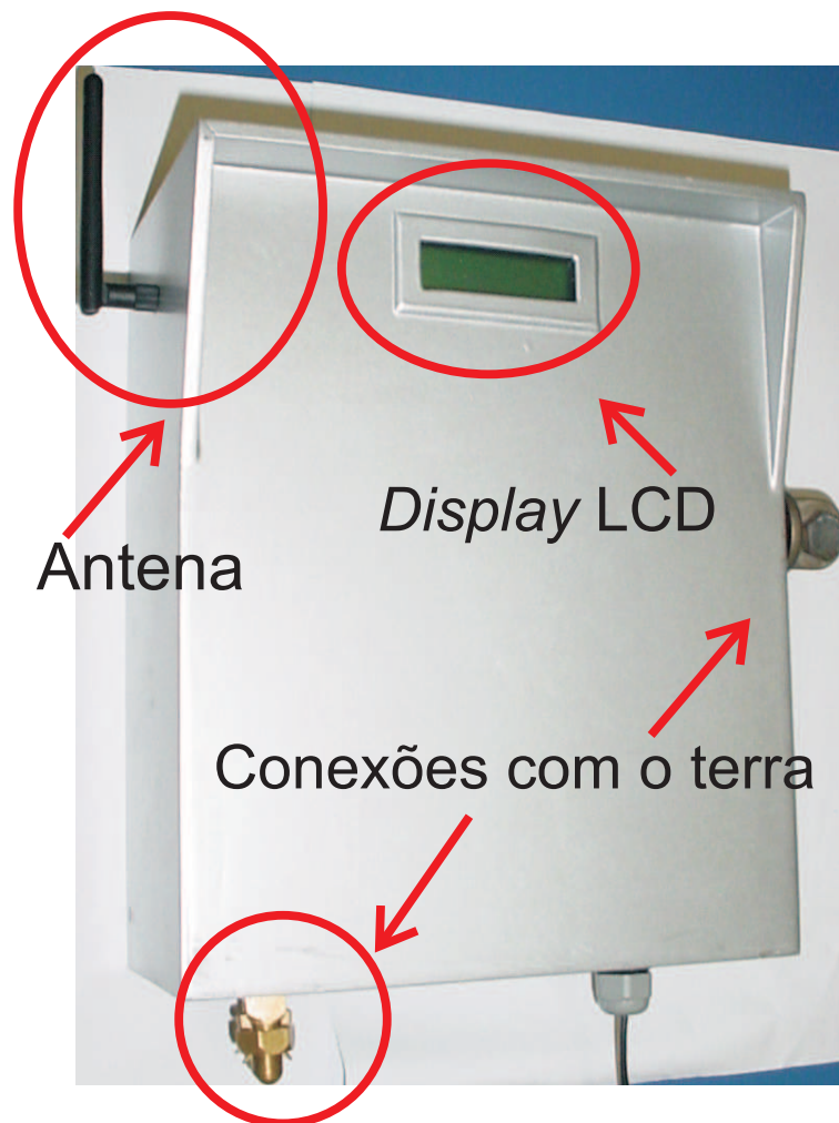
Figura 5.16 – Versão final do sistema de avaliação de para-raios.
