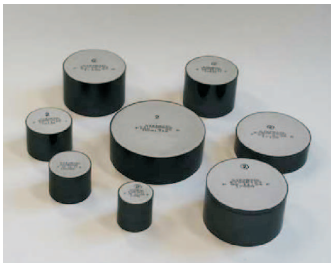
Figura 2.2 – Varistores a base de ZnO (HINRICHSEN, 2001).
