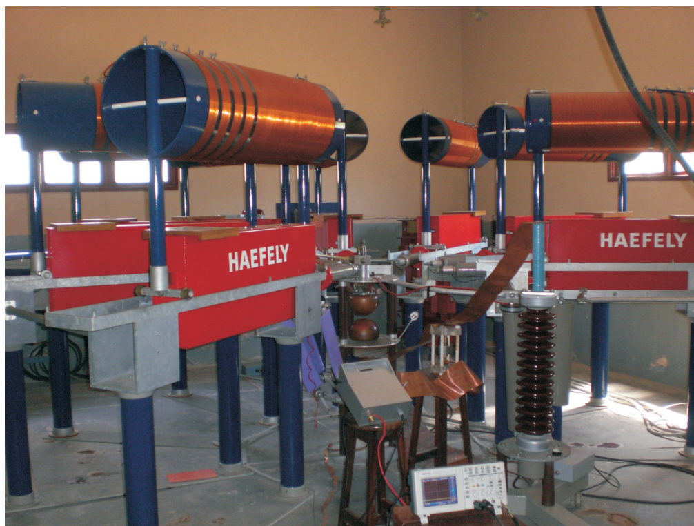
Figura 5.21 – Fotografia do sistema proposto conectado ao gerador de impulsos de corrente.
