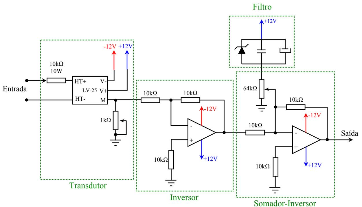
Figura 4.14 – Diagrama elétrico do circuito de condicionamento do sinal.
