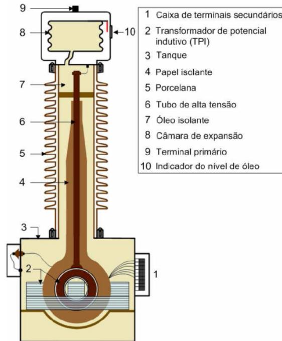
Figura 3.1 – Esquema de um transformador de potencial do tipo indutivo (TPI) (Carvalho Jr., 2008).
