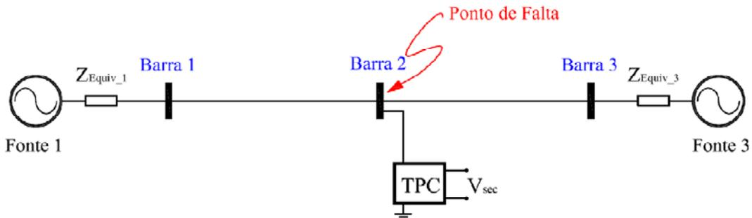
Figura 4.18 – Sistema elétrico adotado para avaliação da compensação na proteção.
