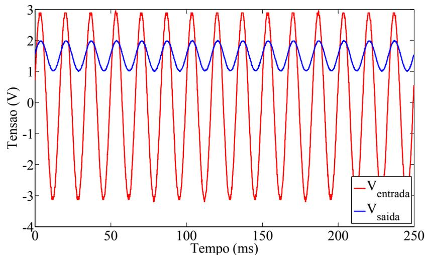
**Figura 5.5 – Formas de onda das tensões de entrada (em vermelho) e de saída (em azul) do circuito condicionador do sinal.**
