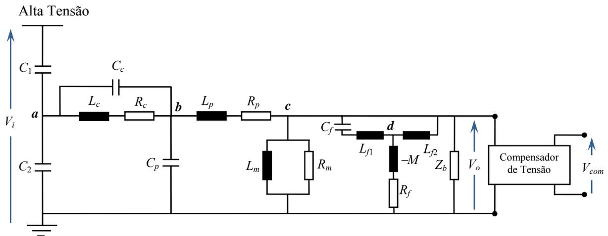
**Figura 4.1 – Esquema elétrico para o TPC compensado.**
