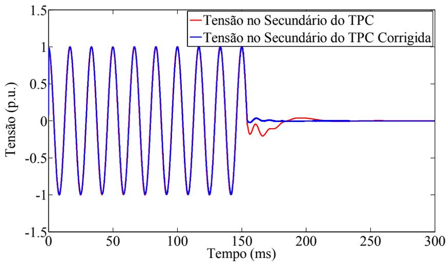
**Figura 5.9 – Atuação do filtro digital recursivo: Caso Teste falta fase-terra.**
