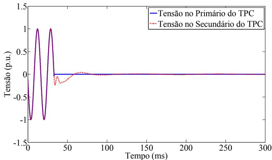
**Figura 5.2 – Formas de onda das tensões no primário e no secundário do TPC durante a ocorrência da falta fase-terra.**
