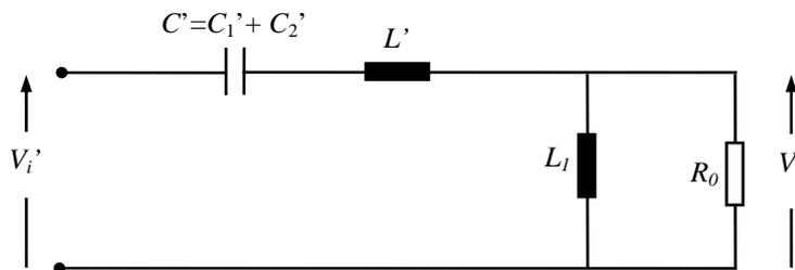
Figura 2.3 – Circuito equivalente simplificado para o TPC com os parâmetros refletidos ao secundário do transformador abaixador, proposto por IZYKOWSKI et al. (1998).
