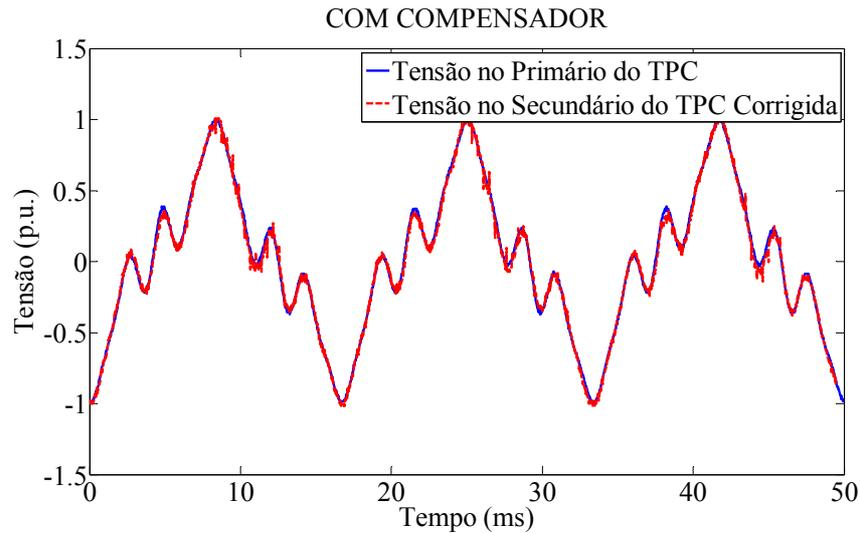
**Figura 5.7 – Funcionamento do TPC com o compensador: formas de onda das tensões no primário (em azul) e no secundário (em vermelho) do TPC.**
