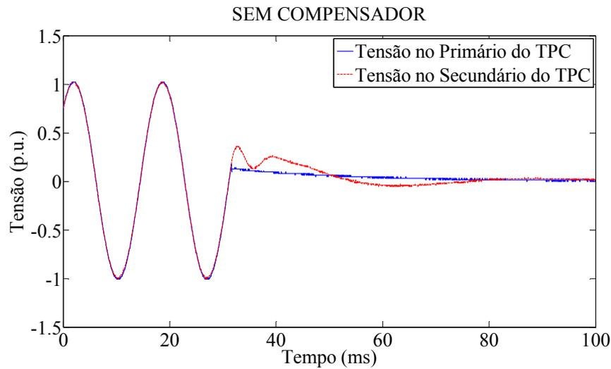
**Figura 5.13 – Funcionamento do TPC sem compensador: formas de onda das tensões no primário (em Azul) e no secundário (em vermelho) do TPC (registro 02 do Caso 1).**
