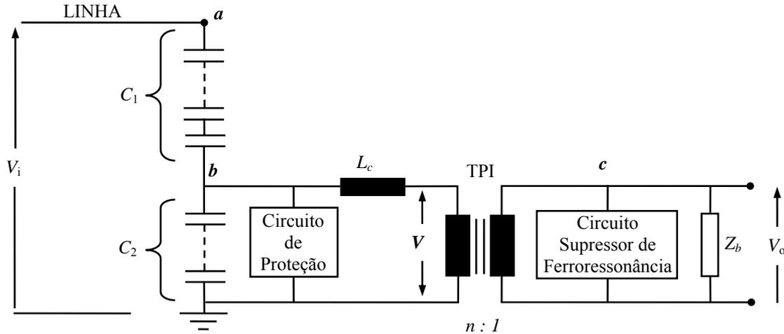
Figura 3.3 - Esquema elétrico básico de um TPC a 60 Hz.
