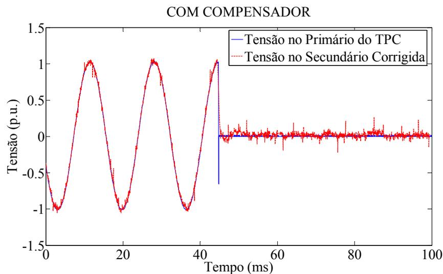
**Figura 5.18 - Funcionamento do TPC com compensador: Formas de onda das tensões no primário (em Azul) e no secundário (em vermelho) do TPC (registro 02 do Caso 2).**
