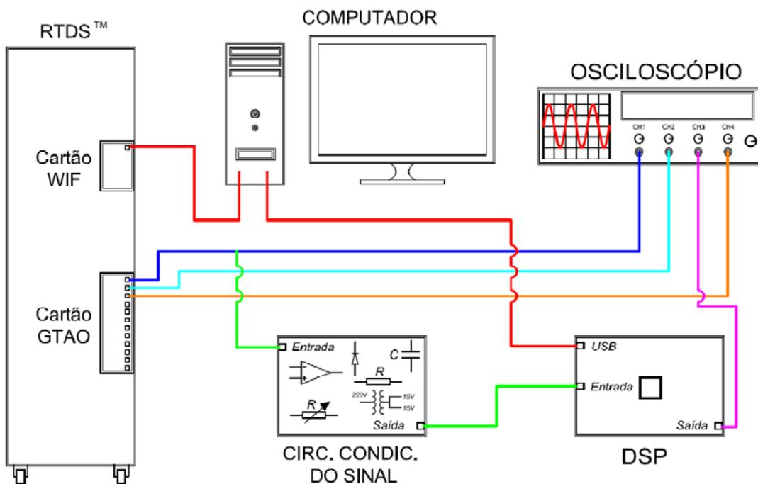
Figura 5.3 – Esquema de montagem utilizado para realizar as simulações em tempo real.
