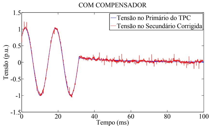
**Figura 5.14 – Funcionamento do TPC com compensador: formas de onda das tensões no primário (em Azul) e no secundário (em vermelho) do TPC (registro 02 do Caso 1).**
