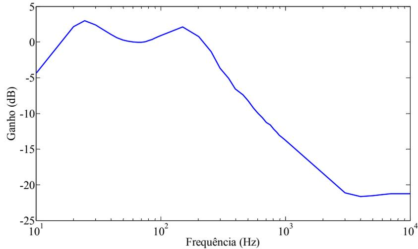
**Figura 4.2 – Curva de amplitude da relação de tensão do TPC de 230 kV.**
