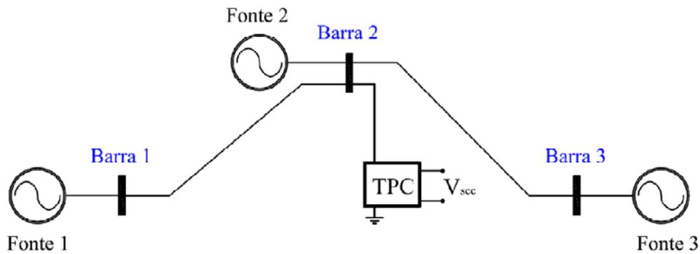
**Figura 4.15 – Sistema elétrico fictício adotado para medição de harmônicos em sistemas de transmissão de 230 kV.**
