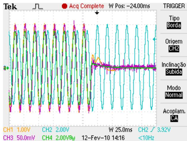
**Figura 5.10 – Imagem da tela do osciloscópio capturada durante a realização das simulações de falta fase-terra, ocorrida no zero da tensão.**
