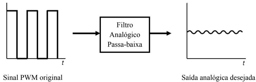
**Figura 4.11 – Filtragem analógica de um sinal PWM.**
