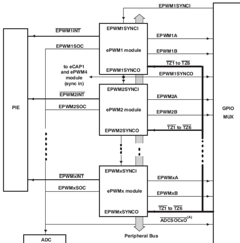
Figura 4.9 – Módulos PWM do TMS320F28335.
