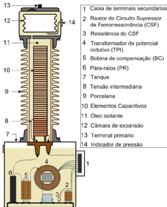
Figura 3.2 - Esquema de um transformador de potencial do tipo capacitivo (TPC) (Carvalho Jr., 2008).
