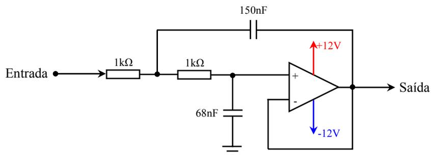
**Figura 4.12 – Estrutura para implementação do filtro ativo passa-baixa de Butterworth de 2ª ordem.**
