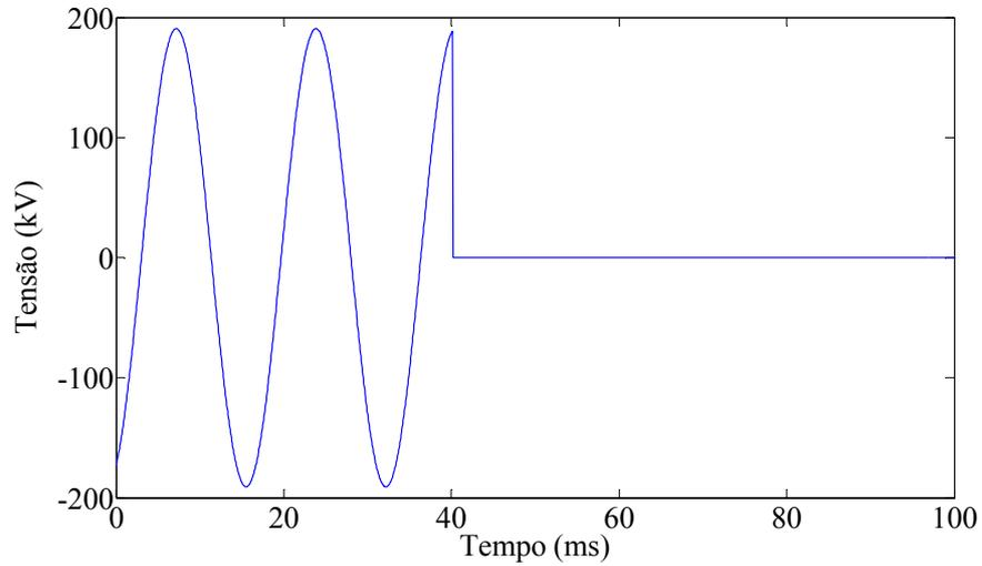
**Figura 5.19 – Forma de onda da tensão no primário do TPC vista no módulo *Runtime* (registro 02 do Caso 2).**
