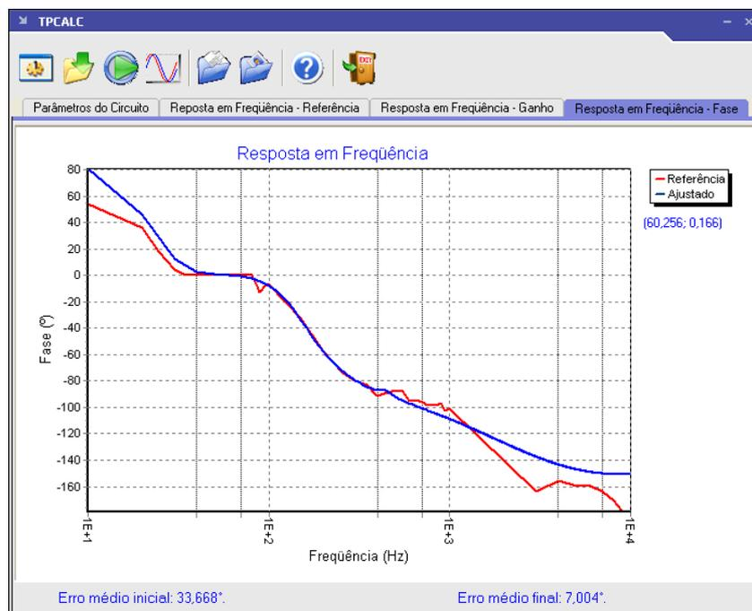
Figura 4.6 - Resposta em frequência de fase do TPC de 230 kV: medida (curva em vermelho); ajustada (curva em azul).
