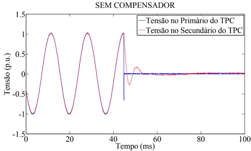
**Figura 5.17 - Funcionamento do TPC sem compensador: Formas de onda das tensões no primário (em Azul) e no secundário (em vermelho) do TPC (registro 02 do Caso 2).**
