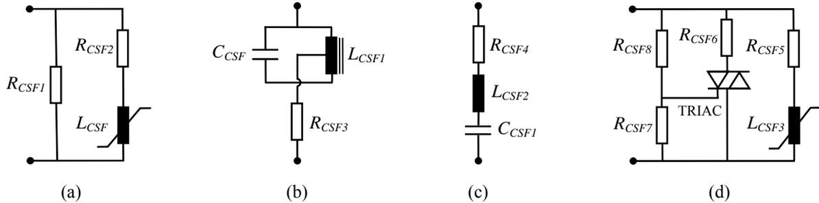
**Figura 3.4 - Exemplos de CSF: (a), (b) e (c) são passivos e (d) é ativo.**
