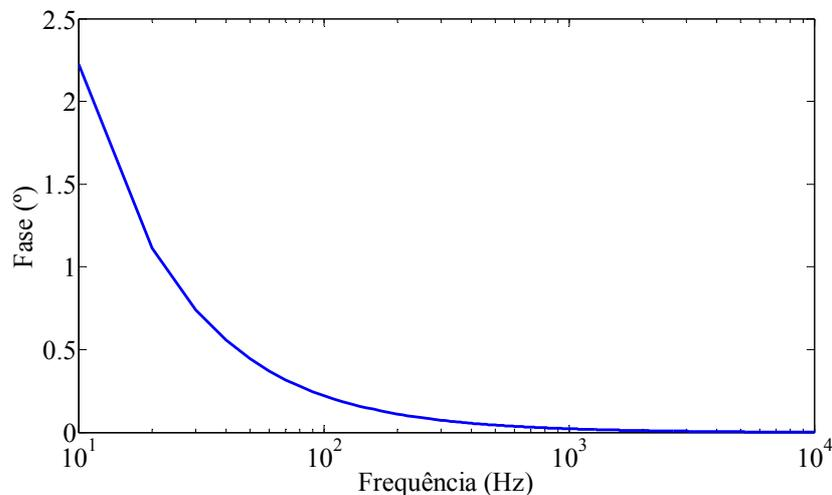
**Figura 4.8 – Curva de resposta em frequência para a fase da relação de tensão do modelo simplificado do TPC.**
