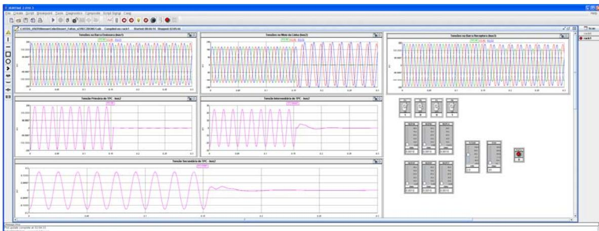
Figura 4.20 – Tela do módulo *RunTime* com a montagem gráfica do sistema elétrico simplificado adotado para o estudo de faltas.
