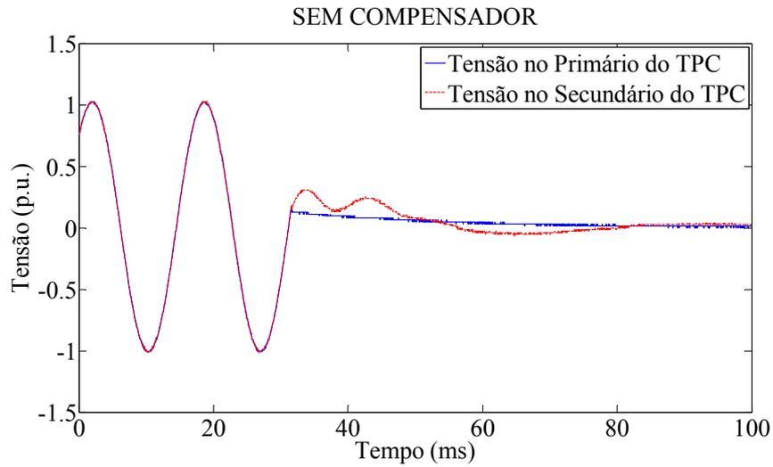
**Figura 5.11 – Funcionamento do TPC sem compensador: formas de onda das tensões no primário (em Azul) e no secundário (em vermelho) do TPC (registro 01 do Caso 1).**
