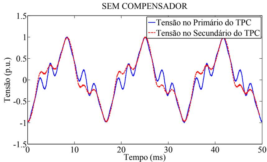
**Figura 5.6 – Funcionamento do TPC sem o compensador: formas de onda das tensões no primário (em azul) e no secundário (em vermelho) do TPC.**
