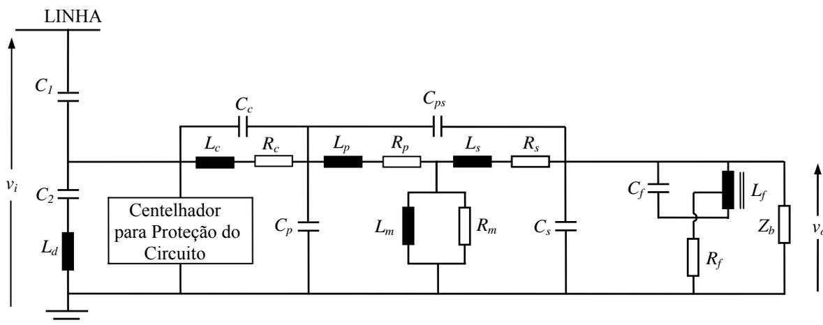
**Figura 3.5 - Modelo geral do TPC para estudos de transitórios eletromagnéticos.**
