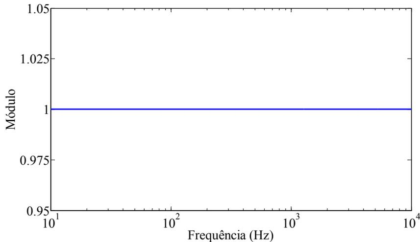
**Figura 4.7 – Curva de resposta em frequência para o módulo da relação de tensão do modelo simplificado do TPC.**
