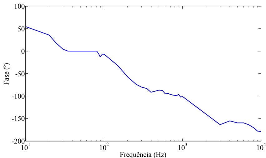
**Figura 4.3 – Curva de fase da relação de tensão do TPC de 230 kV.**
