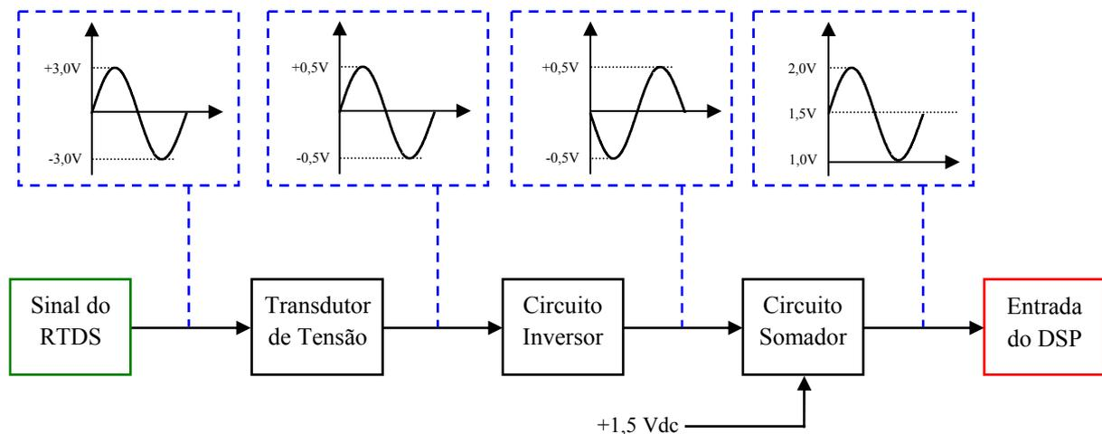
**Figura 4.13 – Diagrama de blocos do circuito de condicionamento do sinal.**
