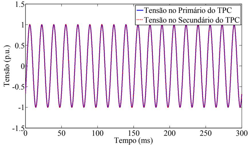
**Figura 5.1 – Formas de onda das tensões no primário e no secundário do TPC em regime permanente.**
