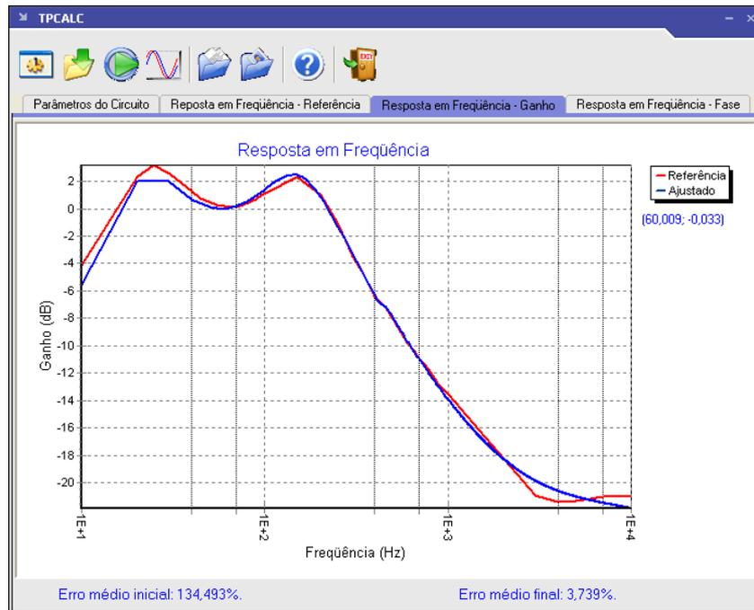
Figura 4.5 - Resposta em frequência de amplitude do TPC de 230 kV: medida (curva em vermelho); ajustada (curva em azul).
