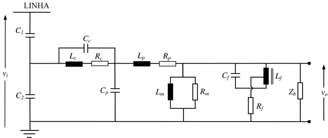
Figura 3.6 - Modelo do TPC adotado para estimação dos seus parâmetros lineares.
