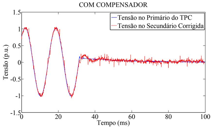
**Figura 5.12 – Funcionamento do TPC com compensador: formas de onda das tensões no primário (em Azul) e no secundário (em vermelho) do TPC (registro 01 do Caso 1).**
