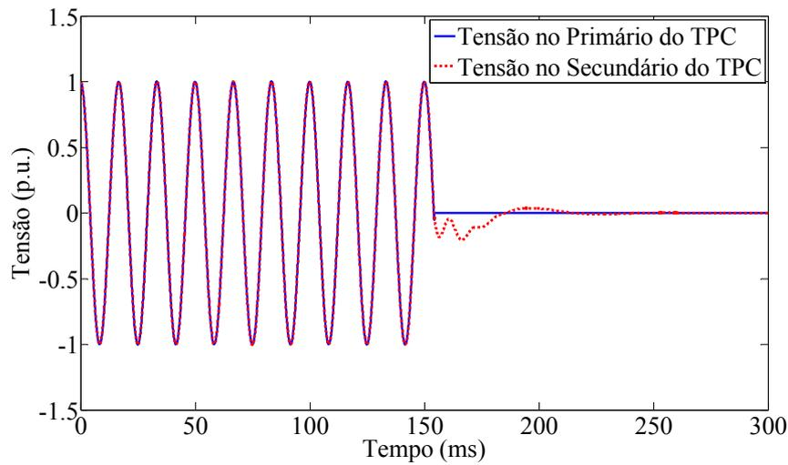
**Figura 5.8 – Formas de onda das tensões no primário e no secundário do TPC conectado a barra 2 do sistema elétrico simplificado durante a ocorrência de uma falta fase-terra.**
