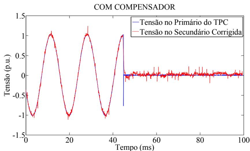
**Figura 5.16 - Funcionamento do TPC com compensador: Formas de onda das tensões no primário (em Azul) e no secundário (em vermelho) do TPC (registro 01 do Caso 2).**
