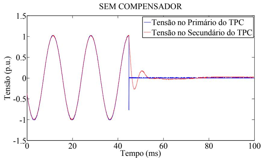
**Figura 5.15 - Funcionamento do TPC sem compensador: Formas de onda das tensões no primário (em Azul) e no secundário (em vermelho) do TPC (registro 01 do Caso 2).**
