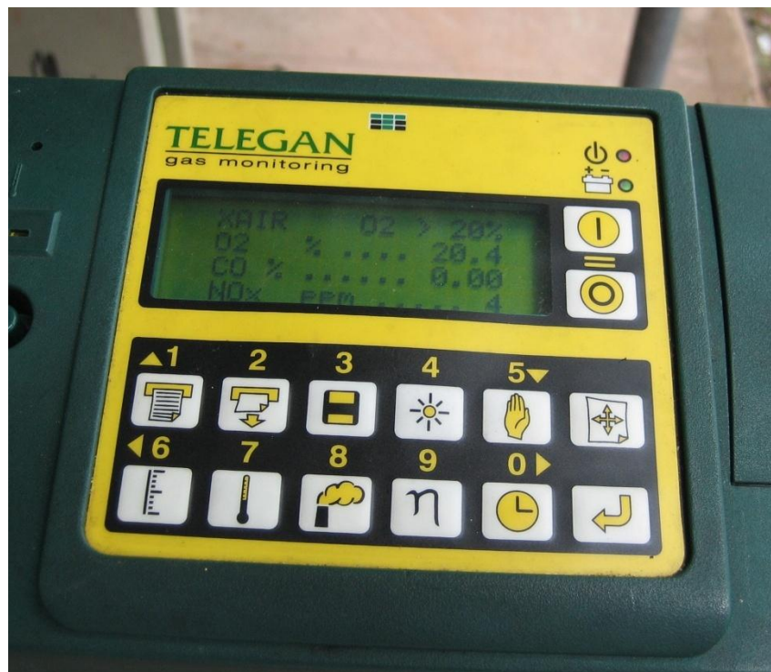
Figura 4.7 – Analisador de gases em operação
