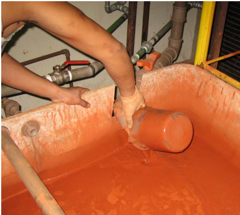
Figura 4.3 – Medição da vazão da fase líquida
