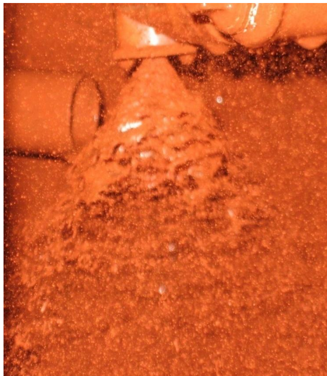
Figura 3.14 – Sistema de aspersão com bicos centrífugos operando com LV.
