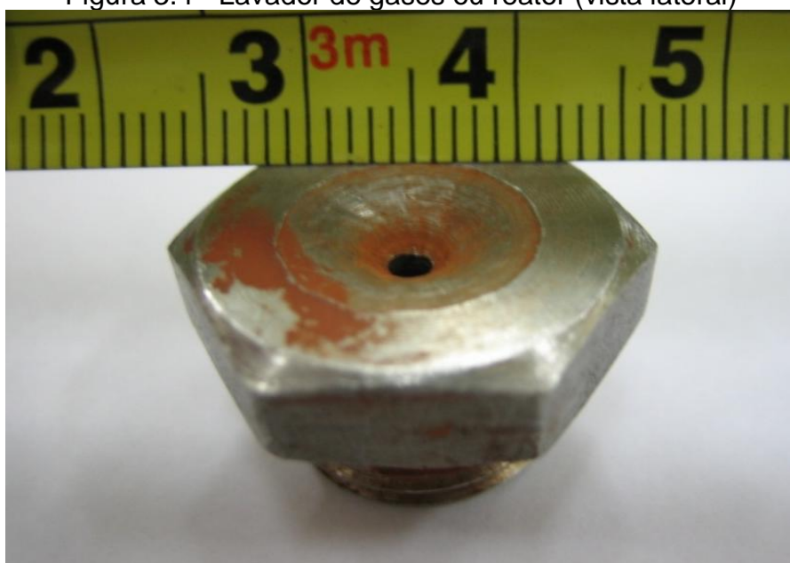
Figura 3.5 – Bico aspersor em aço inoxidável com orifício de 2 mm de diâmetro.
