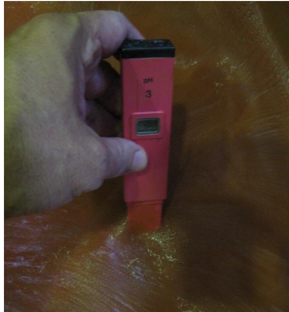
Figura 4.9 - Medição de pH no tanque de LV
