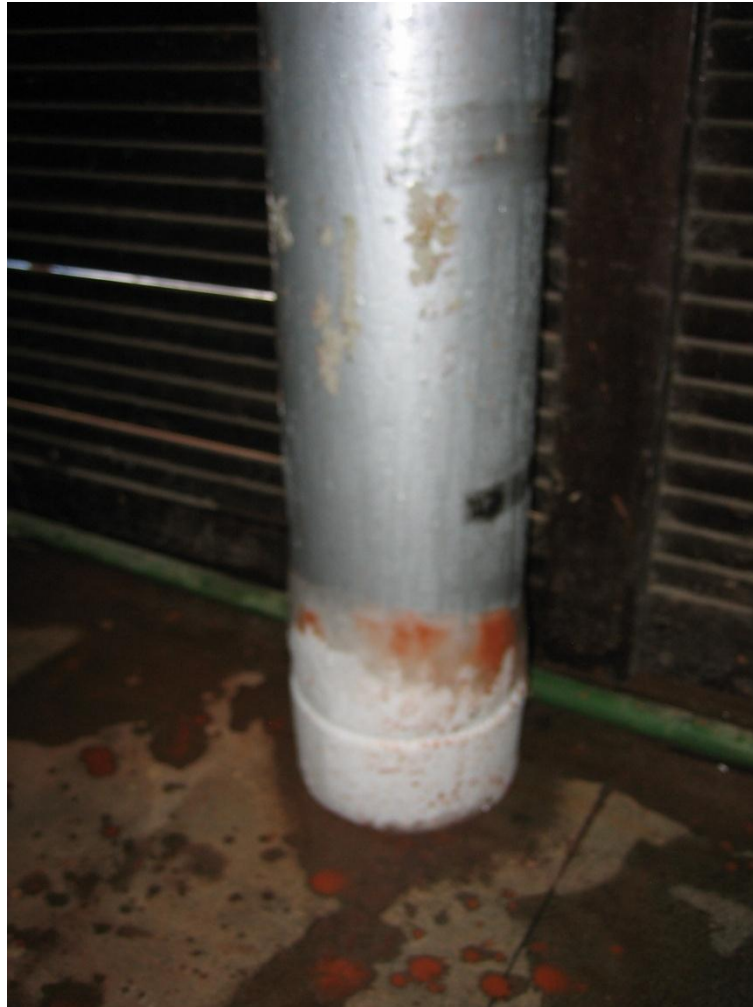
Figura 4.4 - Cilindro contendo CO 2 com uma camada de gelo na parte inferior
