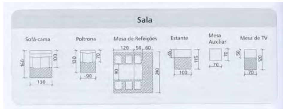
FIGURA 4.13 Dimensões mínimas do mobiliário de referência para projetos de sala. Fonte: Pereira et al, 2002, p.190.
