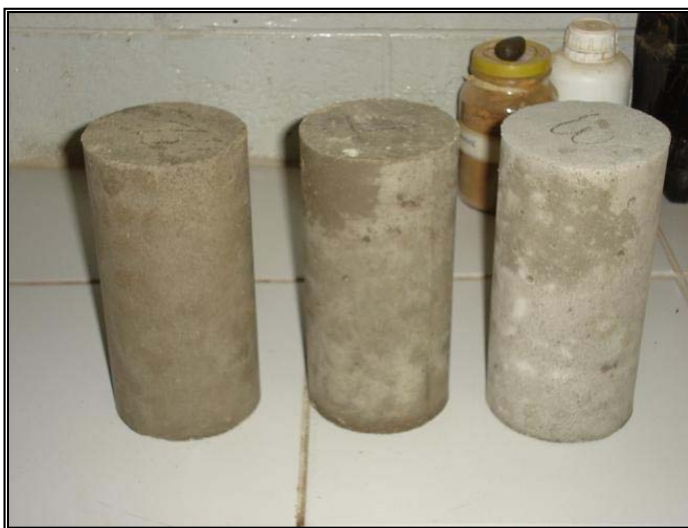
Figura 24: Aparência dos corpos-de-prova referentes aos traços 1:8, 1:6 e 1:4 posicionados nesta ordem da esquerda para a direita.
