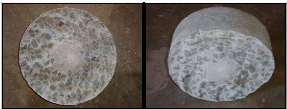
Figura 39: Corpo-de-Prova para o traço de referência logo após o ensaio de desgaste por abrasão.
