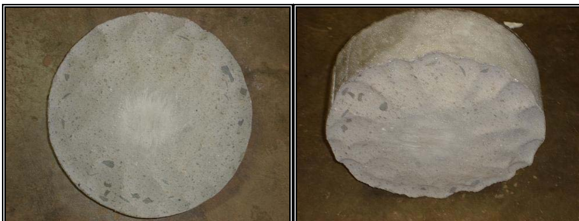
Figura 40: Corpo-de-Prova para o traço com 60% de agregado reciclado logo após o ensaio de desgaste por abrasão.
