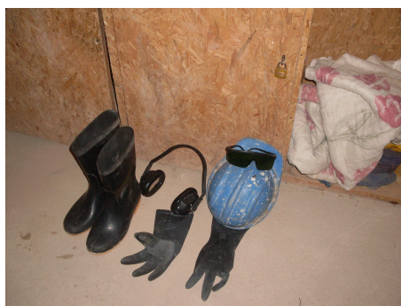
Foto 10 - Equipamentos de Proteção – EPI's. Fonte: BATISTA, José Roberto, Trabalho de Campo, 2009 – 2010.
