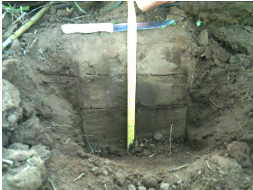
Figura 17. Coleta de solo argissolo nas profundidades 0-5 cm, 5-10 cm e 10-20 cm.
