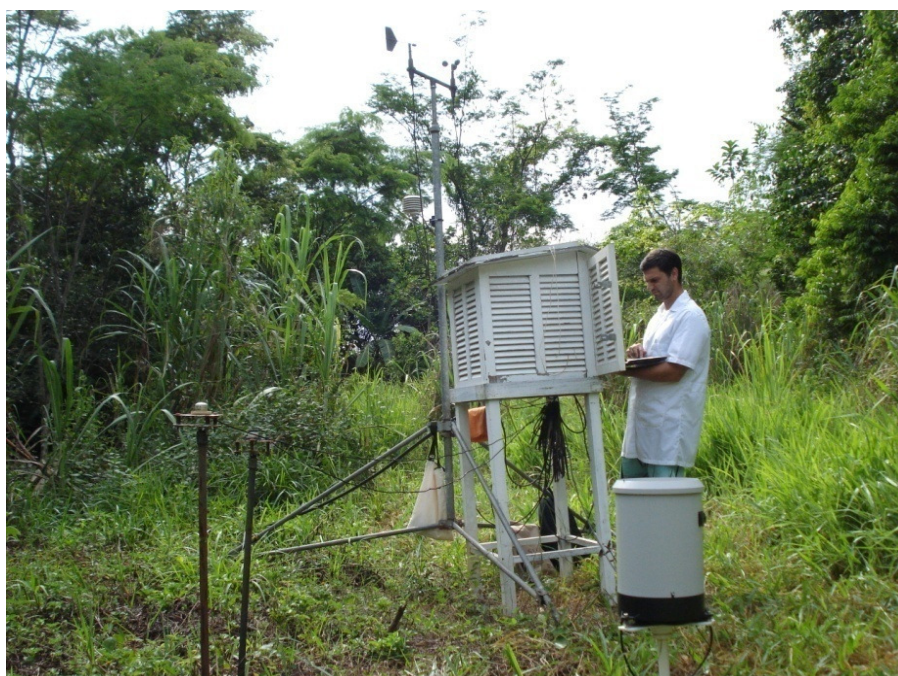
Figura 10 – Estação meteorológica automática instalada na microbacia do Córrego Jaqueira, Alegre-ES.
