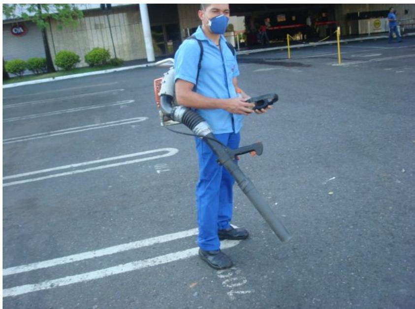
Figura 51 – Sopradores usados para varrição dos estacionamentos
