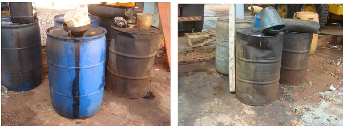
Figura 42 – Armazenagem inadequada de óleo lubrificante usado
