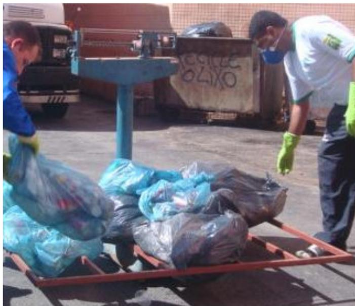
Figura 11 – Balança utilizada na pesagem dos resíduos
