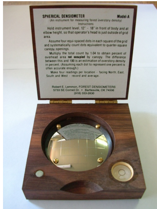
Figura 5 - Foto do Densímetro esférico/Modelo A. Fonte: Ana Claudia Bentancor Araujo.
