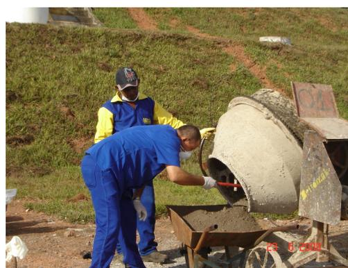
Figura 4.4.3 Retirada do lodo caleado da betoneira
