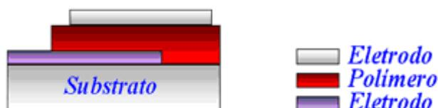
**Figura 2.1** - Representação esquemática dos dispositivos estudados no presente trabalho: estrutura eletrodo/polímero/eletrodo, apoiada em substrato.
