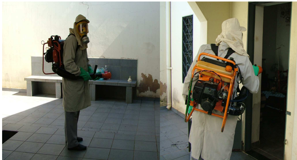
Figura 1. Nebulizador costal da marca Jacto, Modelo Multispray 2000 utilizado na aplicação de malathion para o controle do mosquito transmissor do vírus causador da dengue.
