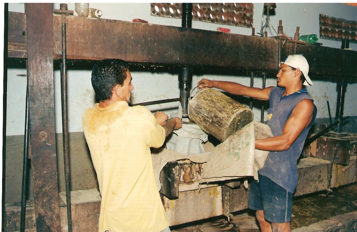
Foto 07 – Na casa de cera o pó é fundido em água fervente, onde é transformado em cera bruta após a secagem.
