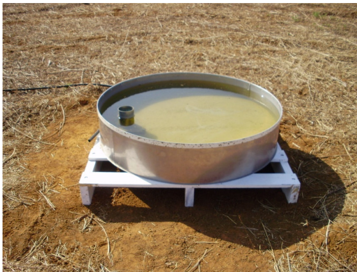
Figura 6 – Tanque Classe “A” instalado na área experimental para a quantificação da evaporação diária.
