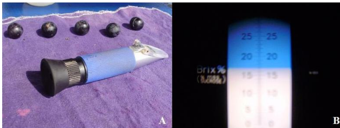
Figura 12 – Refratômetro ocular para a determinação dos sólidos solúveis totais (A) e a imagem da escala graduada em °brix visualizada por este aparelho (B).
