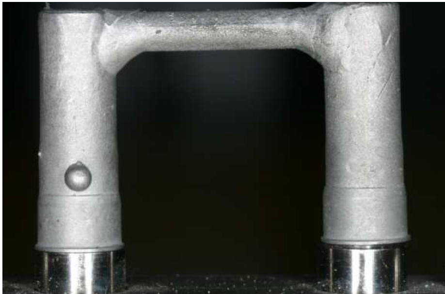
Figura 9. Corpo de prova fundido em monobloco mostrando o desajuste na face vestibular do cilindro direito (teste) em relação ao análogo.
