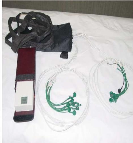
Figura 1: Transmissor por telemetria utilizada na coleta de sinais EMG-s.
