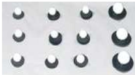
Figura 5: Marcadores retro-refletivos para captação por meio de câmeras de infravermelho.
