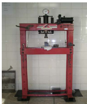
FIG. 53: Prensa uniaxial modelo Schulz modelo PHS 15t, utilizada na etapa de compactação. (EEL-USP-DEMAR)
