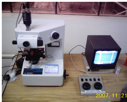
FIG. 58: Microdurômetro Micromet 2004 modelo 1600-4988 - Buehler (EEL-USP-DEMAR).
