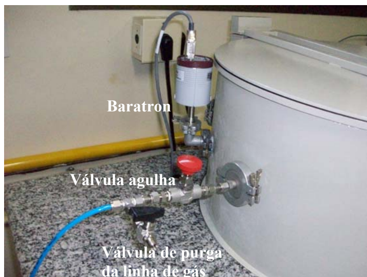
FIG.3.11 Modificação da montagem da válvula de entrada de gás do sistema.
