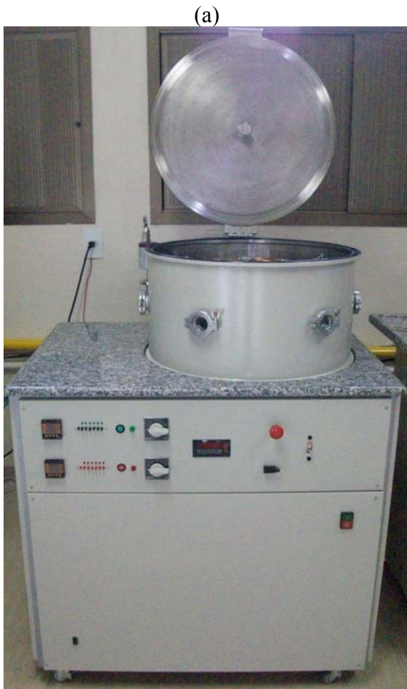
FIG.3.1 Fotografias frontal (a) e lateral (b) do sistema CSS em linha, nas quais se pode observar a campânula, com seus flanges soldados, montada sobre o rack.
