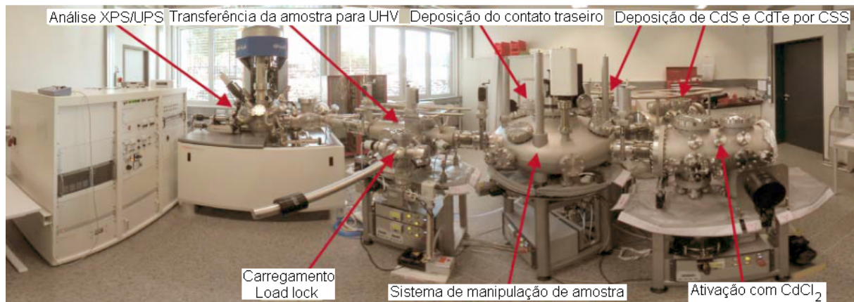
FIG.1.8 Sistema DAISY-SOL (Darmstadt Integrated System for Solar energy research): o substrato de vidro/ITO/SnO 2 é inserido para dentro do sistema de vácuo através da câmara de carregamento e, a seguir, são realizadas as deposições por CSS de CdS e CdTe, a ativação por CdCl 2 e a formação do contato traseiro, em câmaras separadas, conectadas a um sistema de manipulação de amostra (FRITSCHÉ et al., 2005; SPÄTH et al., 2004).
