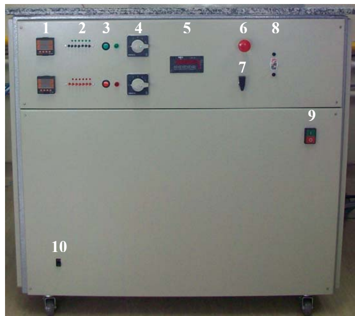
FIG.3.10 Painel frontal montado com dois controladores/programadores (1) e chaves seletoras do termopar (2) e chaves comutadoras do aquecedor (4). Podem-se observar também os interruptores de alimentação dos aquecedores (3), o mostrador de pressão (5), a válvula de entrada de gás do sistema e de purga (6), a válvula de admissão de ar atmosférico (7), a chave da válvula pneumática para selamento do sistema (8), a chave da bomba (9) e, por fim, a chave geral (10).
