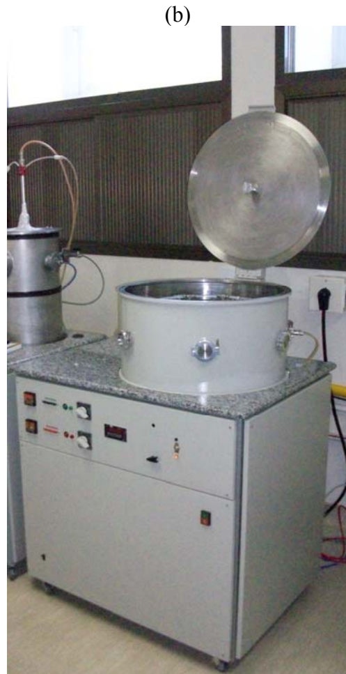
FIG.3.1 Fotografias frontal (a) e lateral (b) do sistema CSS em linha, nas quais se pode observar a campânula, com seus flanges soldados, montada sobre o rack.
