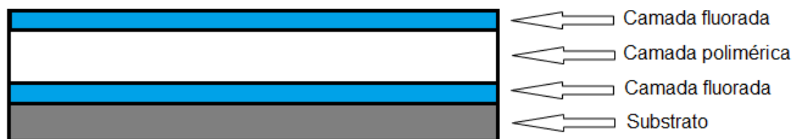
Figura 9: Esquema dos filmes PMMA depositados sobre substrato de silício (Giacon (2004)).
