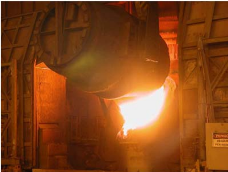
Figura 4.3 – Foto do processo de carga de gusa no convertidor MRP na Aciaria.
