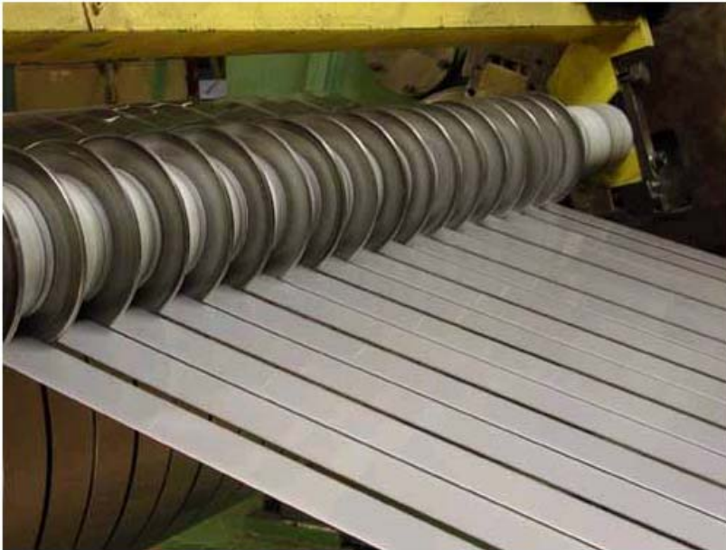
Figura 4.7 – Foto da bobina sendo recortada em tiras na tesoura transversal.
