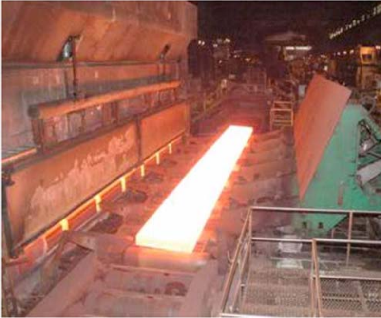
Figura 5.5 – Foto da placa posicionada para início de laminação a quente.
