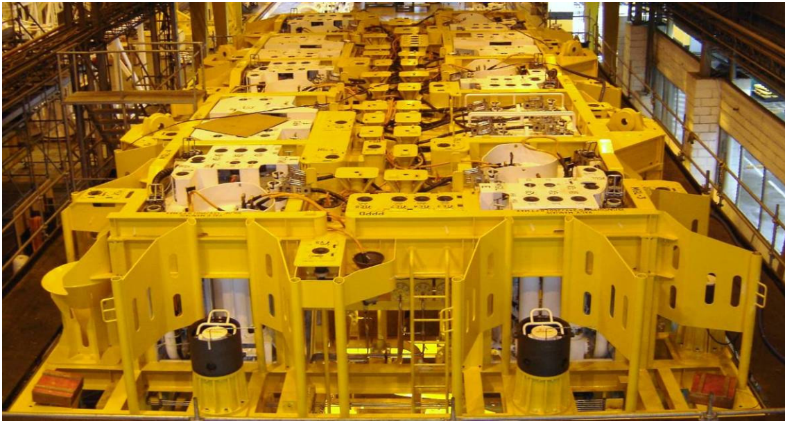
Figura 7. Exemplo de manifold com mandris para conexão remota (Cortesia de FMC Technologies)
