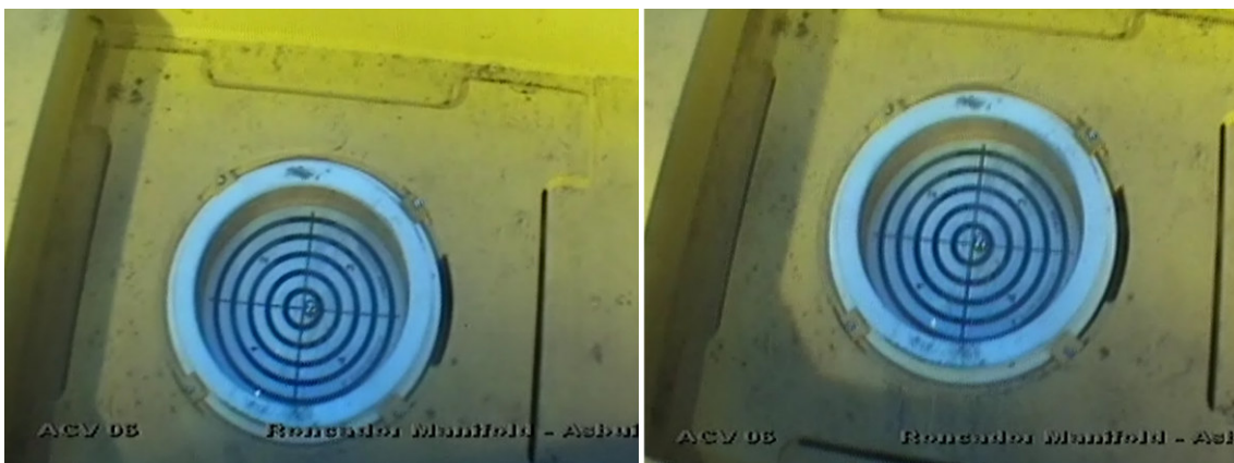
Figura 20. Inspeção submarina: dispositivo de verificação de inclinação do equipamento (Cortesia de Petrobras)
