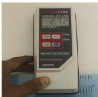
Figura 22 - Densitômetro Victoreen modelo 07-443
