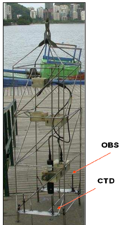
Figura 6: Estrutura de aço utilizada para o fundeio, ainda sem o ADV.
